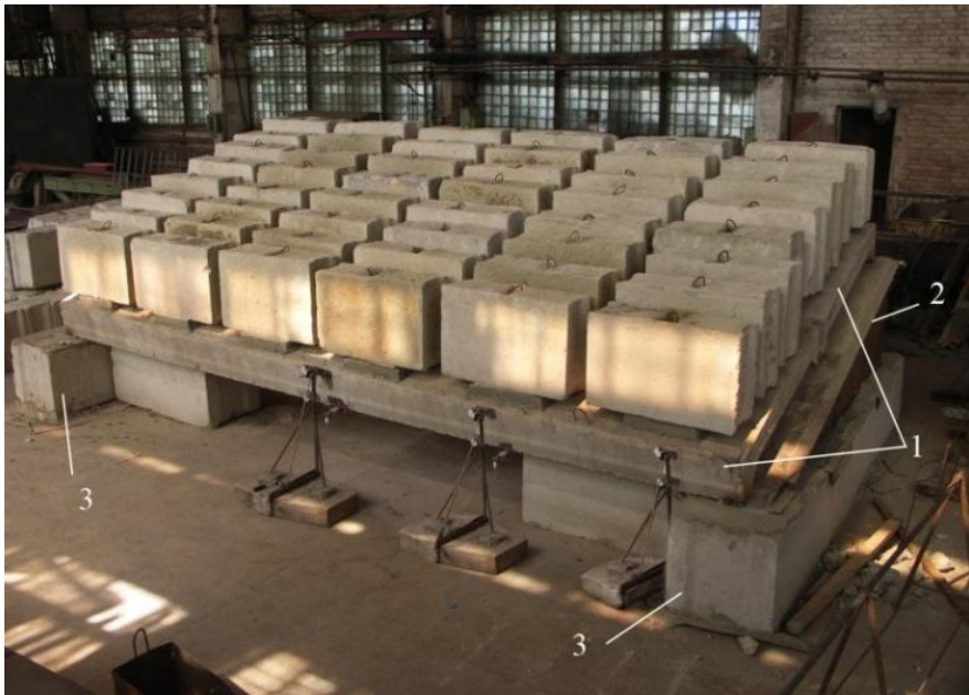
Рисунок 3 – Общий вид испытаний фрагмента железобетонного складчатого покрытия: 1 - ребристые плиты, 2 – сталебетонная опора – диафрагма, 3 – бетонные опоры
