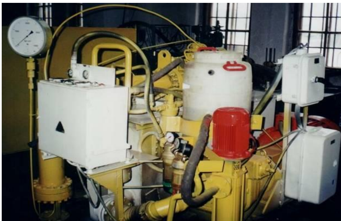
Рисунок 1- Насосная установка для получения высоконапорной водяной струи
