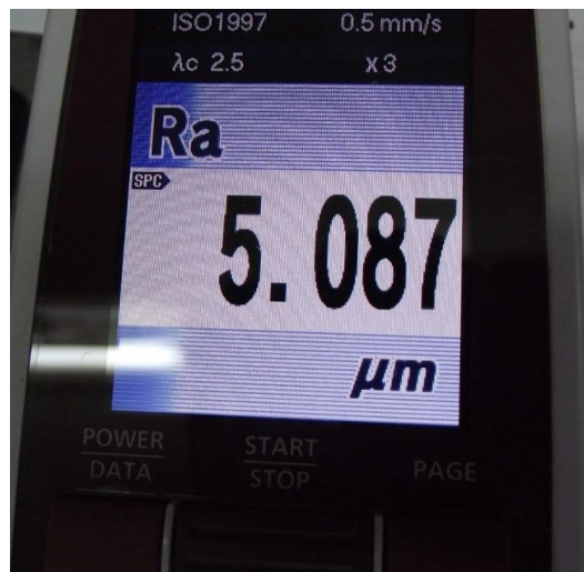
Рисунок 2 – Результаты замеров шероховатости расточенной поверхности стандартным резцом
