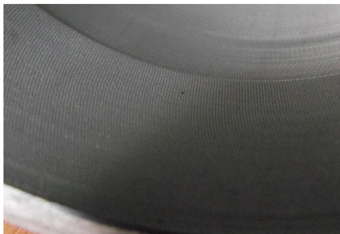
Рисунок 1 – Фотография поверхности детали, полученной расточкой стандартным инструментом
