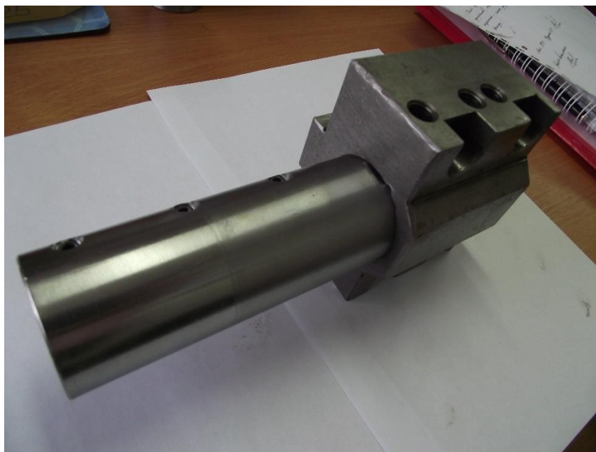
Рисунок 5 – Держатель осевого инструмента токарного станка с установленной специальной оправкой
