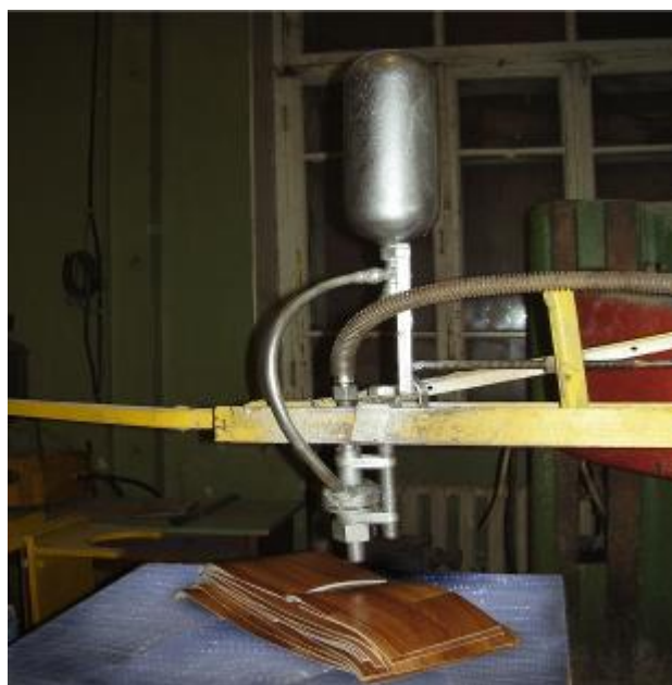
Рисунок 3 - Струеформирующий аппарат для разрезания пакета материала водолеяной струей высокого давления
