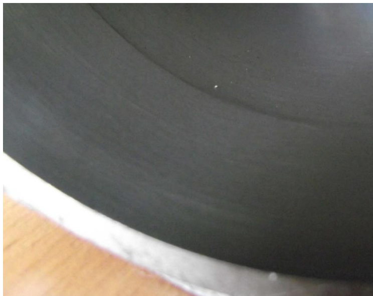
Рисунок 6 – Фотография поверхности детали, полученной расточкой с применением специальной оправки
