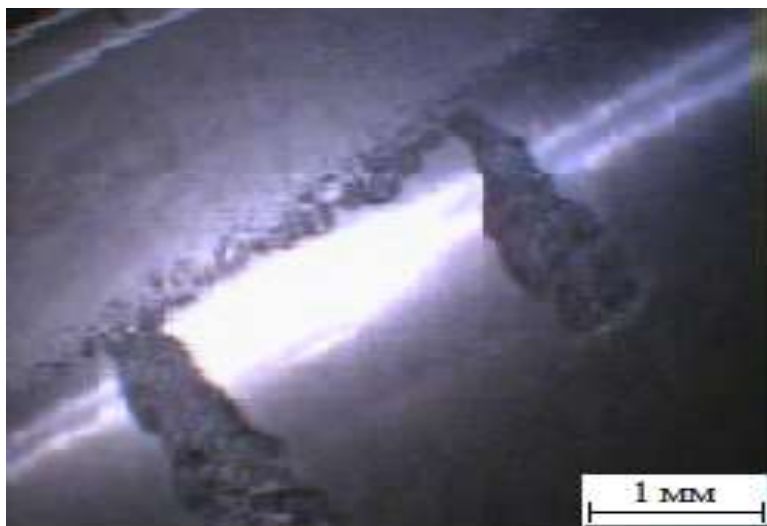
Рисунок 3 – Изображение стенки цилиндра двигателя, полученное с помощью технического эндоскопа
