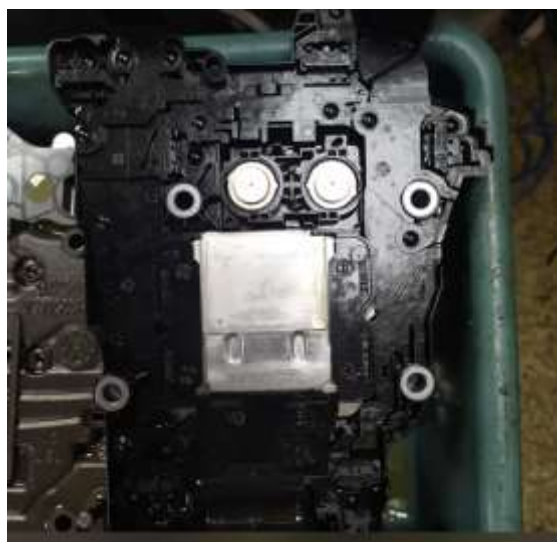
Рисунок 8 - Круглые датчики давления сцепления на электронной плате маховика
