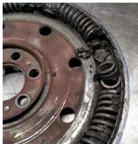
Рисунок 5 - Износ радиальных пружин маховика
