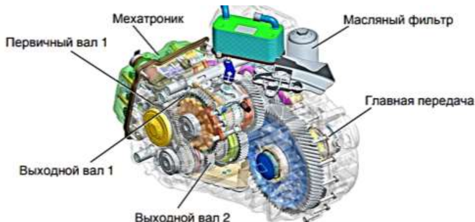
Рисунок 1 - Устройство РКПП DSG
