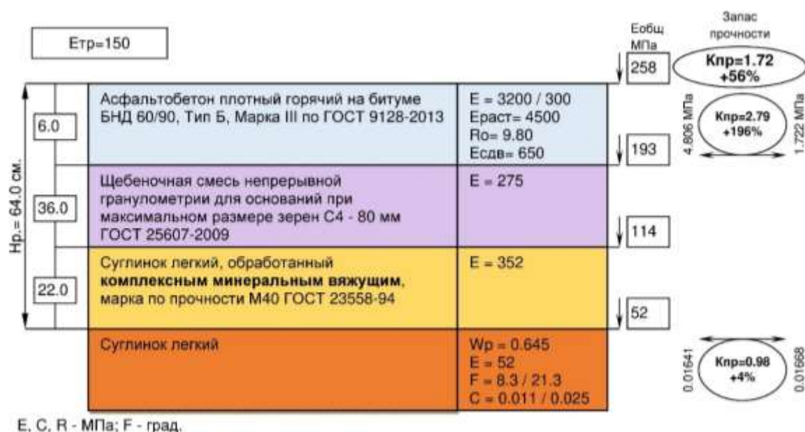
Рисунок 2 – Конструкция дорожной одежды облегченного типа с использованием грунта, укрепленного комплексным минеральным вяжущим
