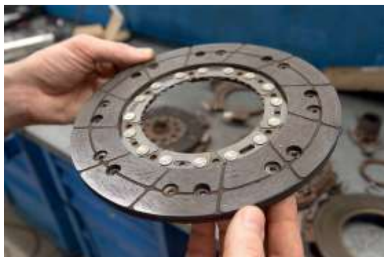
Рисунок 4 - Изношенный фрикционный слой диска сцепления
