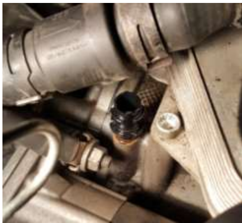
Рисунок 6 - Масляное запотевание клапана сапуна
