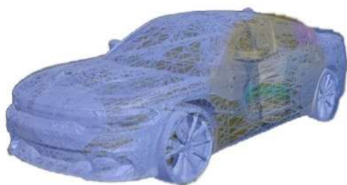
Рисунок 11 – Тепловая карта распределения значений коэффициента Гука боковой части кузова Dodge Charger
