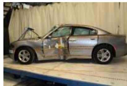
Рисунок 5 – Dodge Charger в результате столкновения с сконцентрированной деформирующей силой
