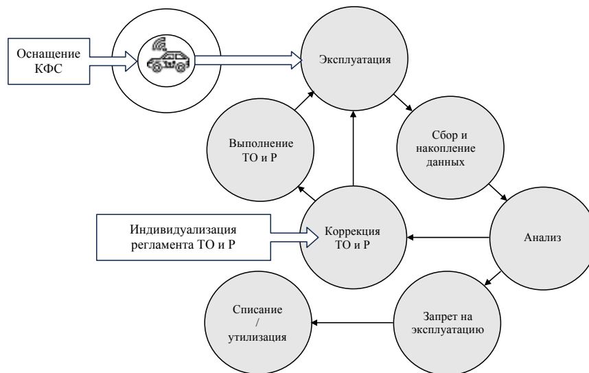
Рисунок 1 – Структурная логическая схема этапа эксплуатации в жизненном цикле ВАТС
