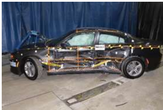
Рисунок 2 – Dodge Charger в результате столкновения с деформирующей силой, распределенной по всей площади боковой части кузова
