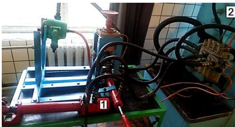
Рисунок 3 – Лабораторная установка для исследований ММ АСУД ТТМ: 1 – ГОРУ; 2 – КИ-4200
