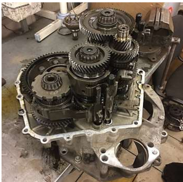
Рисунок 2 – DSG-7 DQ-200 в разобранном состоянии
