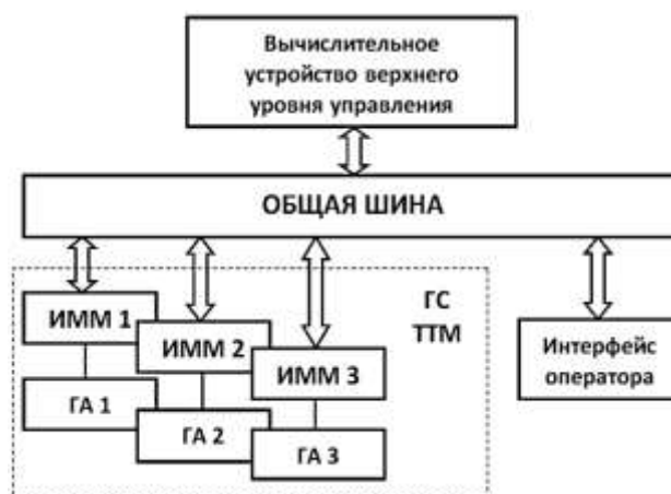
Рисунок 7 – Схема архитектуры PCY для автоматизации работы гидроагрегатов при комплексной гидрофикации (обозначения в тексте)
