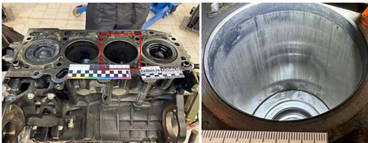
Рисунок 1, 2 - Повреждение 3-го цилиндра ДВС
