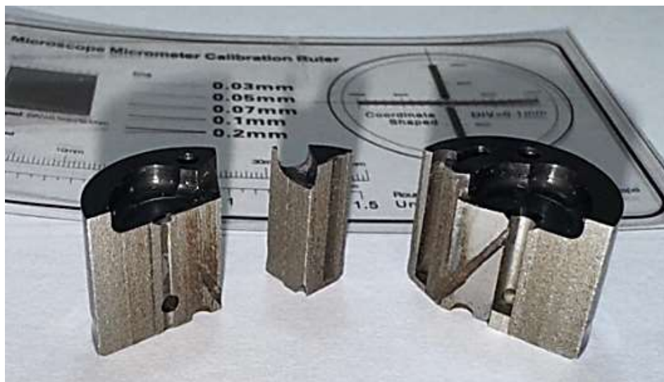
Рисунок 5 - Вид разрезанного обратного клапана
