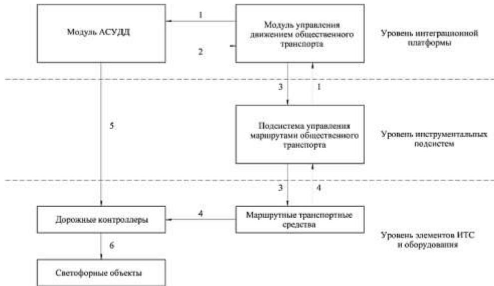
**Рисунок 3 – Физическая архитектура ПОПП ПТПОП, обладающего возможностью автоматической идентификации ТС:** 1 – отправка запроса на приоритетный проезд; 2 – информирование о возможности предоставления приоритета; 3 – информирование о предоставлении приоритета; 4 – передача данных об общественном транспорте; 5 – отправка сценария управления светофорного управления; 6 – передача управляющего сигнала
