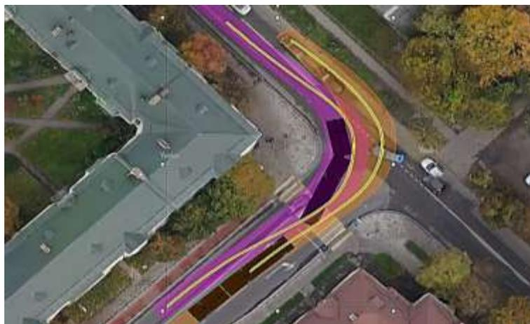
Рисунок 4 – Траектории моделей сочлененных автобусов на пересечении ул. Автомобильной и ул. Батальной
