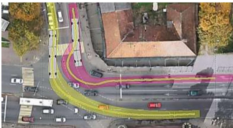
*Рисунок 3 – Траектории моделей сочлененных автобусов на пересечении ул. Литовский вал – Московский пр-т*
