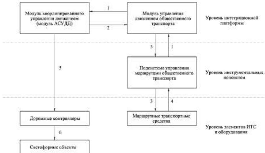
**Рисунок 4 – Физическая архитектура ПОПП ПТПОП при объединении функциональных возможностей модуля координированного управления движением и модуля АСУДД:** 1 – отправка запроса на приоритетный проезд; 2 – информирование о возможности предоставления приоритета; 3 – информирование о предоставлении приоритета; 4 – передача данных об общественном транспорте; 5 – отправка сценария управления светофорного управления; 6 – передача управляющего сигнала
