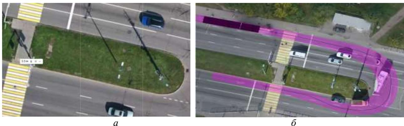
Рисунок 2 – Динамический коридор сочлененного автобуса при развороте
