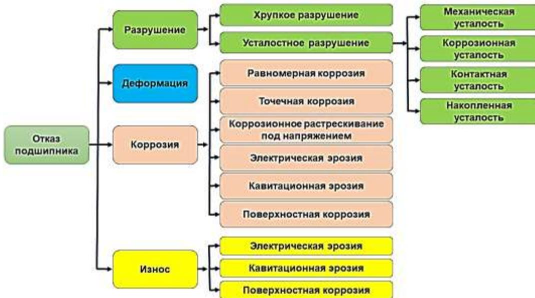
Рисунок 1 – Структурная схема наиболее распространённых отказов подшипников
