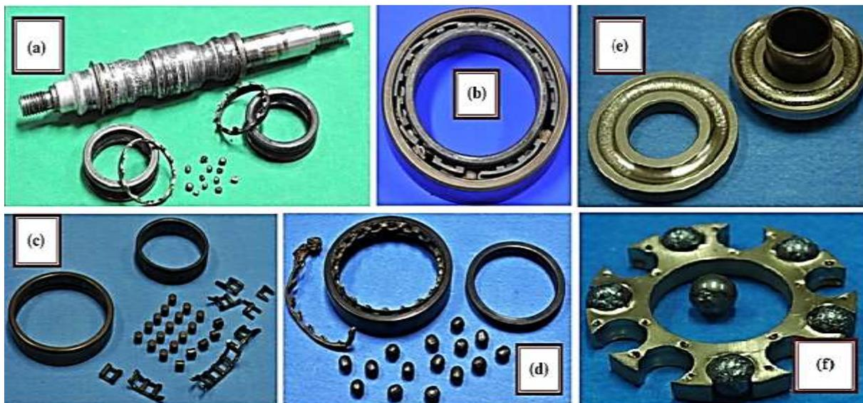
Рисунок 2 – Фотографии вышедших из строя компонентов различных подшипников в исходном состоянии: а - подшипник В-1, b - подшипник СМВ-1, с - подшипник СМВ-1, d - подшипник СМВ-2, e - EDP-1, f - EDP-1
