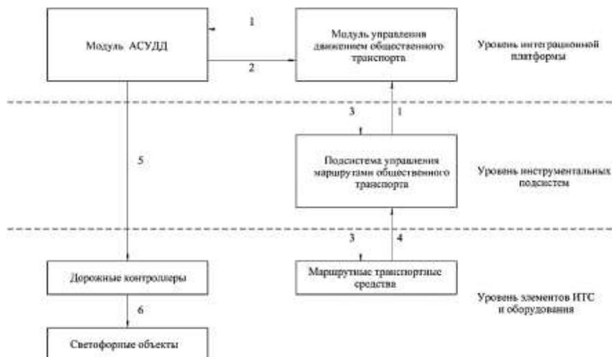
**Рисунок 2 – Физическая архитектура ПОПП ПТОП, не обладающего возможностью автоматической идентификации ТС: 1 – отправка запроса на приоритетный проезд; 2 – информирование о возможности предоставления приоритета; 3 – информирование о предоставлении приоритета; 4 – передача данных об общественном транспорте; 5 – отправка сценария управления светофорного управления; 6 – передача управляющего сигнала**
