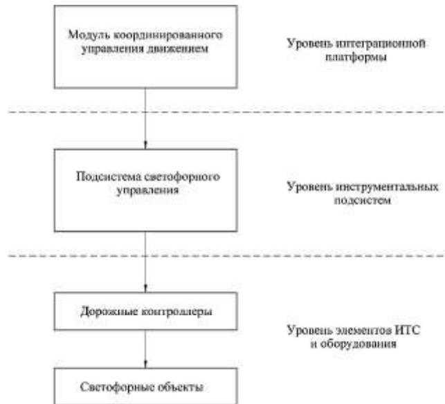
**Рисунок 1 – Физическая архитектура ПСУ [2]**
