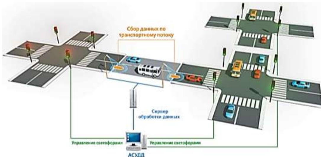
Рисунок 6 – схематичное отображение адаптивного управления
