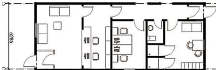
Рисунок 4 - Помещения для приёмки, технического узла, котельной, зоной отдыха, кафе и туалетное помещение
