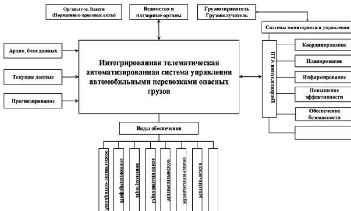
Рисунок 2 - Концептуальная модель формирования интегрированной телематической автоматизированной системы управления автомобильными перевозками опасных грузов
