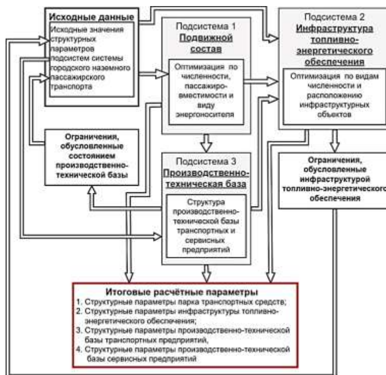
Рисунок 5 – Схема взаимного влияния структурных параметров подсистем городского пассажирского транспорта
