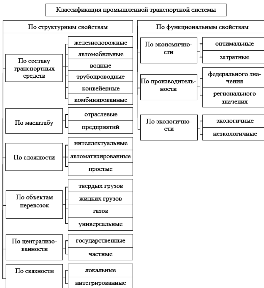
Рисунок 1 - Классификация промышленных транспортных систем по структурным и функциональным свойствам (составлено автором)
