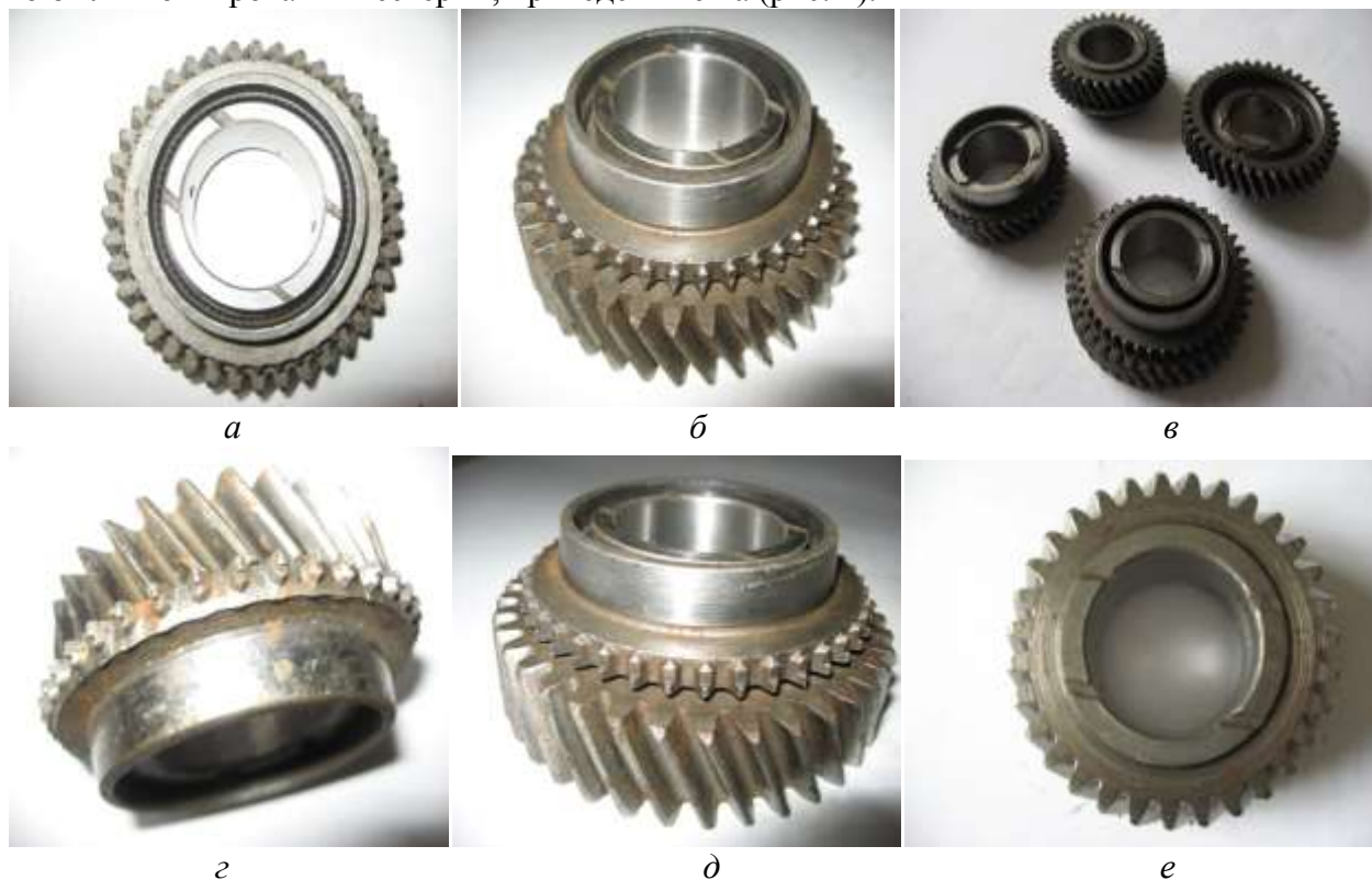
Рисунок 4 - Шестерни коробки передач производства ООО «Нижегородские моторы», износ боковых поверхностей которых составляет 80% от предельно допустимого: а - первой ступени; б - второй ступени; в - третьей ступени (два комплекта); г – задней ступени, д - ступени постоянного зацепления; е - пятой ступени (два комплекта)
