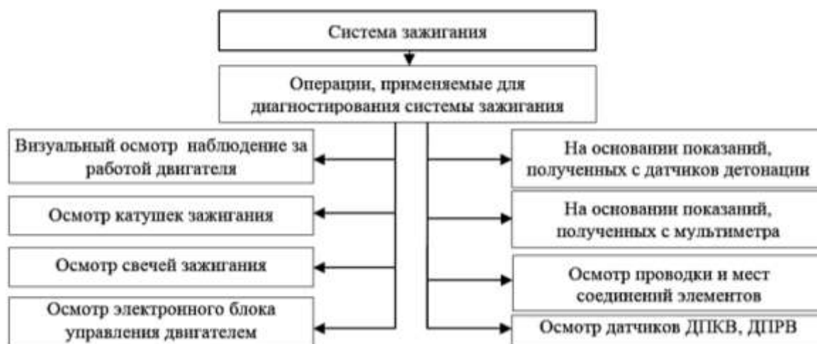
Рисунок 1 - Способы диагностирования системы зажигания двигателя внутреннего сгорания транспортных средств
