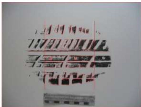
Рисунок 7 – Определение удельной площади пятна контакта протектора шины с дорогой
