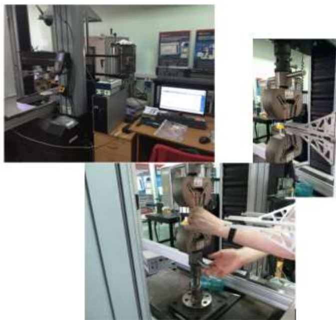
Рисунок 9 – Определение параметров материала изготовления грунтозацепов колеса
