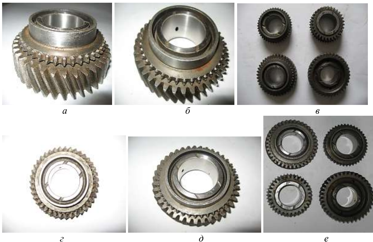
Рисунок 3 - Шестерни коробки передач производства ООО «Нижегородские моторы», износ боковых поверхностей которых составляет 2% от предельно допустимого:
