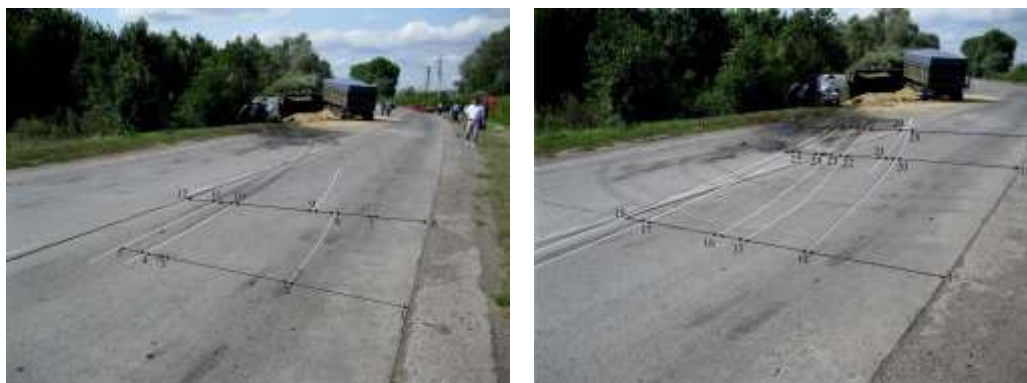
Рисунок 5 – Разметка следовой информации на снимке с места дорожно-транспортного происшествия
