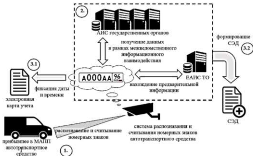
Рисунок 1 – Механизм формирования СЭД на подконтрольную товарную партию на основании номерных знаков автотранспортного средства при его прибытии в МАПП:
