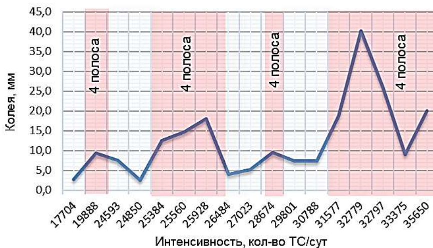
Рисунок 10 – Динамика изменения величины колеи на участках с различной интенсивностью движения (левая колея)
