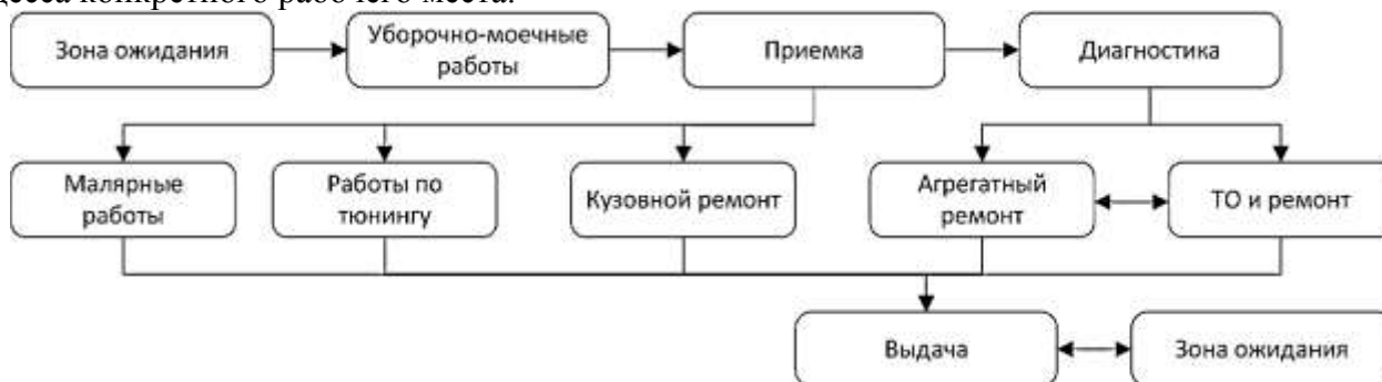
Рисунок 2 – Общий технологический процесс автосервисного предприятия
