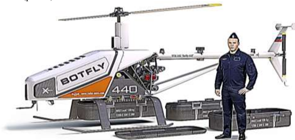
Рисунок 4 - Многоцелевое беспилотное воздушное судно вертолетного типа одновинтовой схемы с рулевым винтом производства ОА «НПО «Радар ммс»
