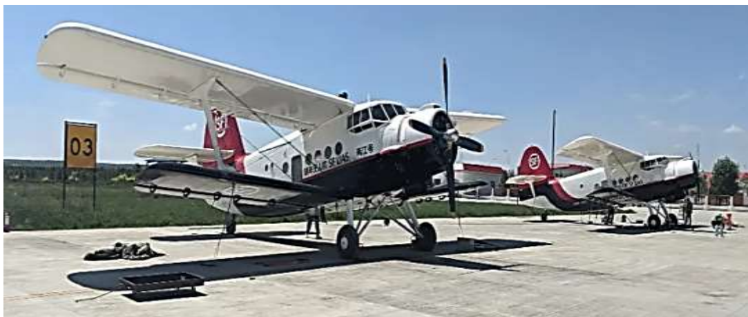
Рисунок 3 - Беспилотный самолет FH-98 на базе многоцелевого биплана Y-5B
