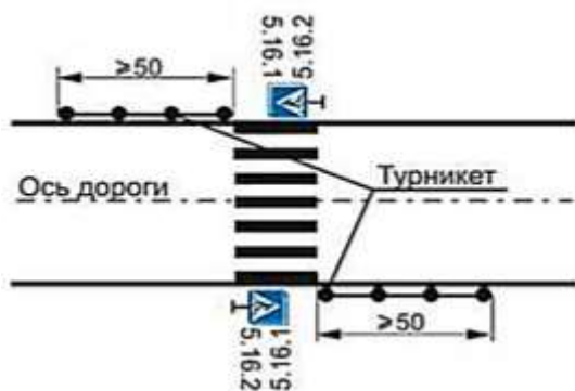
Рисунок 4 – Установка турникета на магистральных улицах в зоне пешеходного перехода [5]
