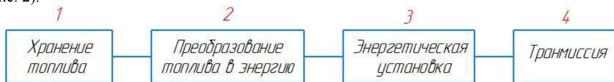
Рисунок 2 – Системы преобразования и (или) передачи энергии в части «силовая установка – трансмиссия» транспортного средства
