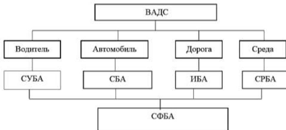
Рисунок 1 – Взаимосвязь систем ВАДС и СФБА: СУБА – система управления БА; СБА – беспилотный автомобиль; ИБА – инфраструктура БА; СРБА – среда БА
