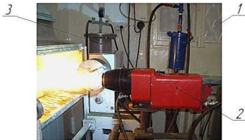
**Рисунок 2 – Электродуговой металлатор в работе с гидродиспергатором для аэрозольного флюсования:**
