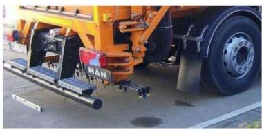
Рисунок 6 – Вид задней рейки с форсунками
