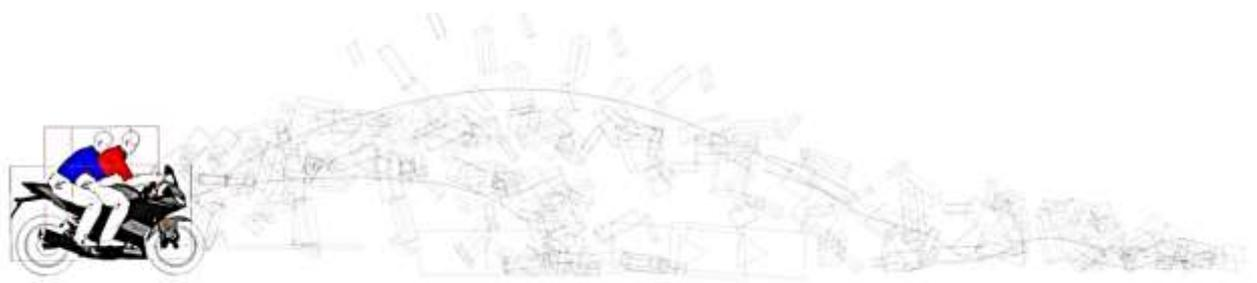
**Рисунок 2 – Пример траекторий сброса водителя и пассажира мотоцикла, полученных в ходе исследования (отображение перемещений ТС-мишени отключено)**
