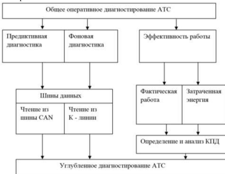
Рисунок 1 – Направления общего оперативного диагностирования
