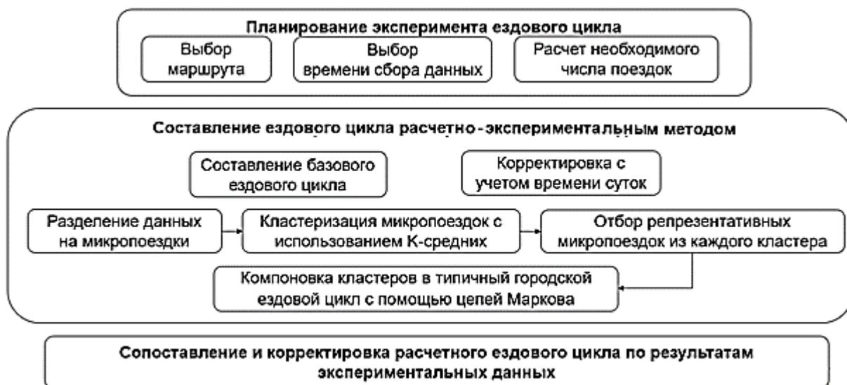
Рисунок 1 – Блок-схема методики разработки ездового цикла
