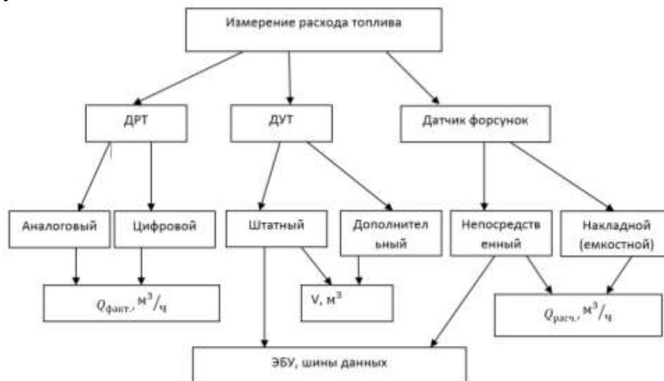
Рисунок 3 - Методы измерения расхода топлива на АТС
