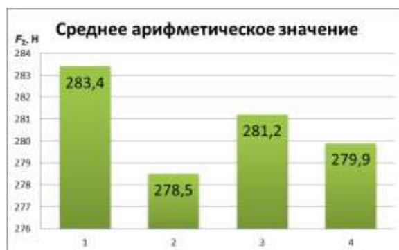
Рисунок 2 - Значение рабочей нагрузки пружин, 1 вариант.
