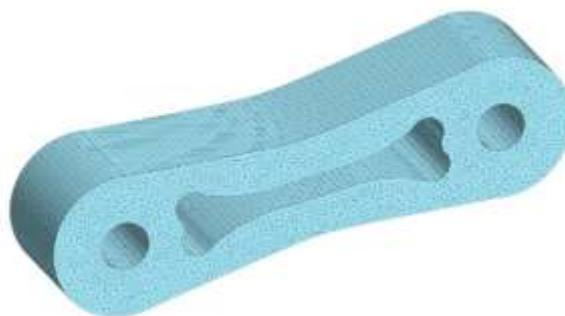
Рисунок 3 – Сетка конечных элементов детали «серьга»
