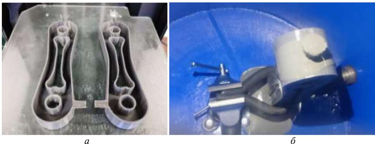
Рисунок 4 – а - отпечатанные полумодели детали «Серьга»; б – процесс заполнения пустотелой оболочки жидким металлополимером
