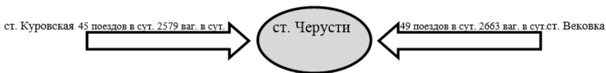
Рисунок 3 – Схема вагонопотоков и поездопотоков на стыковой ст. Черусти
