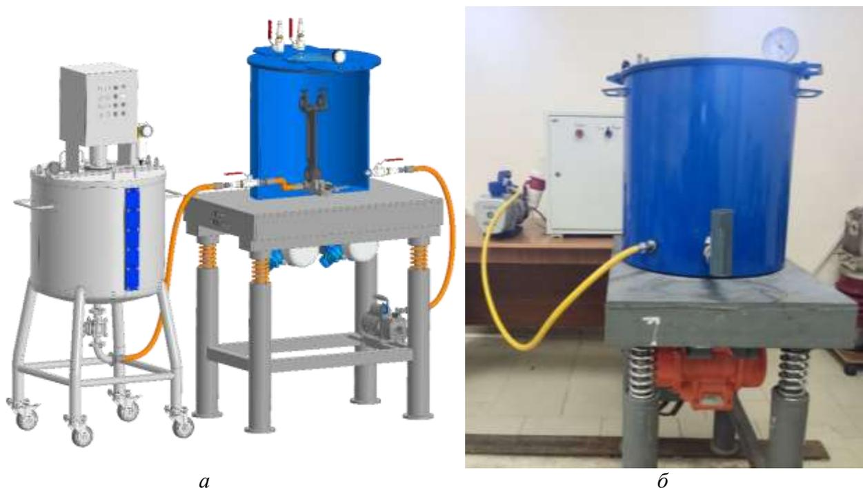
Рисунок 2 – Цифровая модель спроектированного лабораторного устройства и его физическая модель: а -цифровая модель вибро-вакуумного устройства для изготовления композитных деталей; б – лабораторная установка для реализации технологического процесса заполнения оболочковых форм металлополимером
