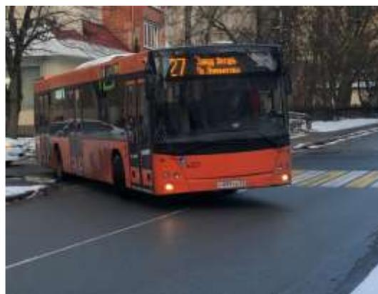
*Рисунок 1 – Выезд автобуса на полосу встречного движения, по причине малого радиуса поворота пересечения*
