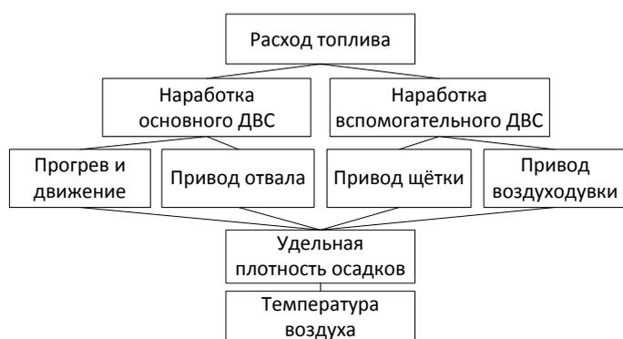
Рисунок 5 – Структура системы формирования расхода топлива снегоуборочными автомобилями
