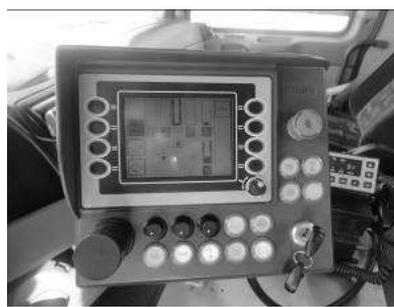
*Рисунок 3 – Бортовой компьютер и блок управления навесным оборудованием*
