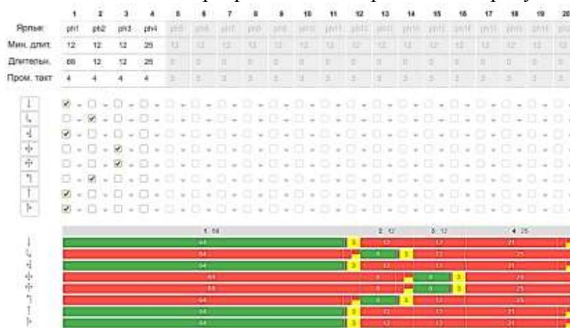
**Рисунок 4 – Моделирование графика режима работы светофорной сигнализации**
