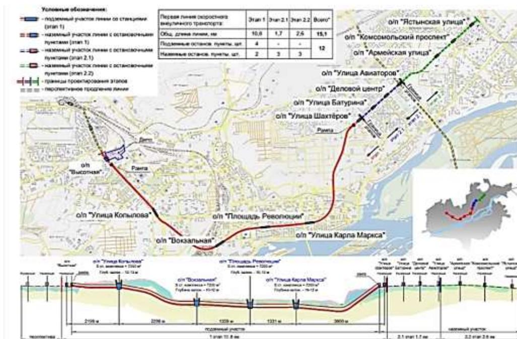
Рисунок 5 - Схема строительства первого этапа линии метротрамвая в г. Красноярске
