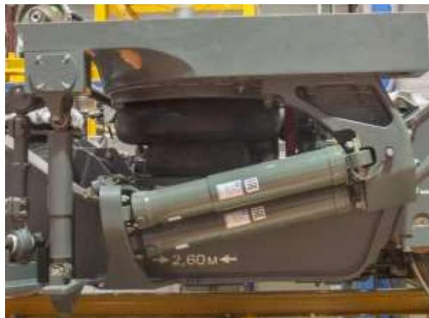
Рисунок 2 - Гидравлические гасители колебаний виляния электропоезда «Сапсан»
