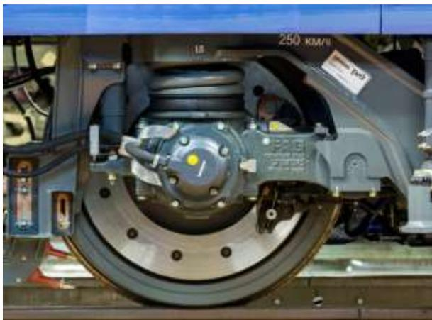
Рисунок 1 - Конструкция связи корпуса буксы с рамой тележки электропоезда «Сапсан»
