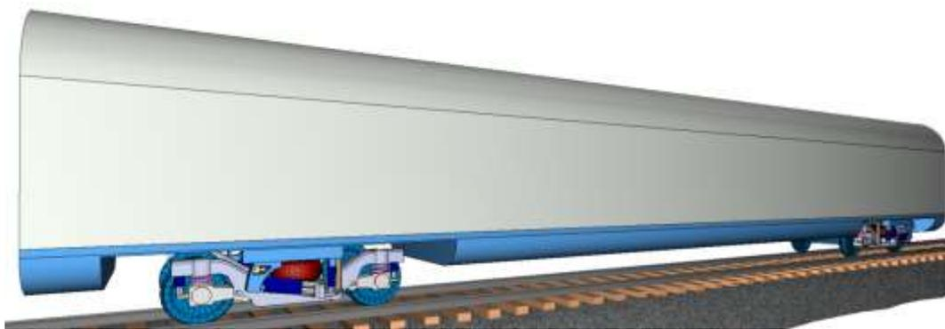
Рисунок 5 – Общий вид модели немоторного вагона электропоезда «Сапсан» в УМ
