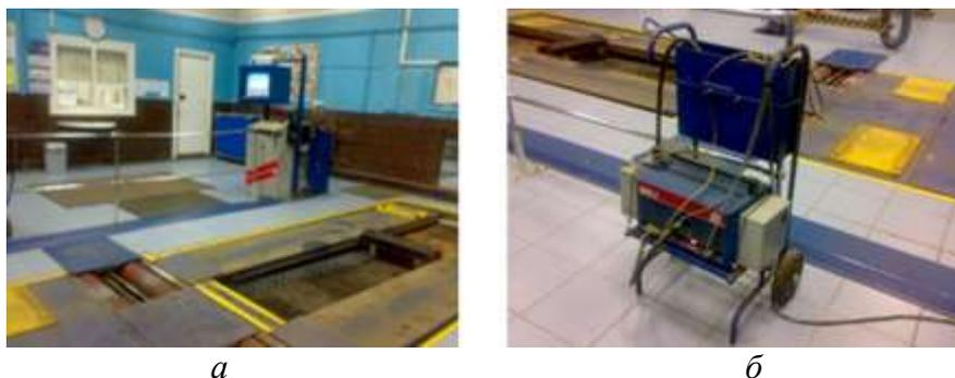
Рисунок 2 – Станция ИБДД СПбГАСУ: а - фото оборудования; б - фото дымомера
