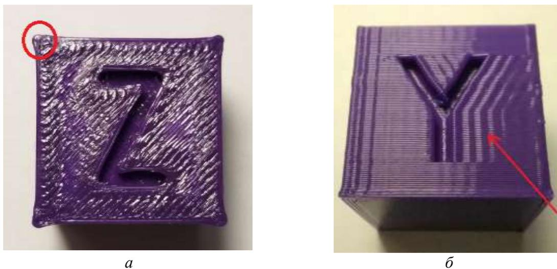
Рисунок 1 – Дефекты, возникающие при прототипирование деталей: а – выпирающие углы; б- рябь
