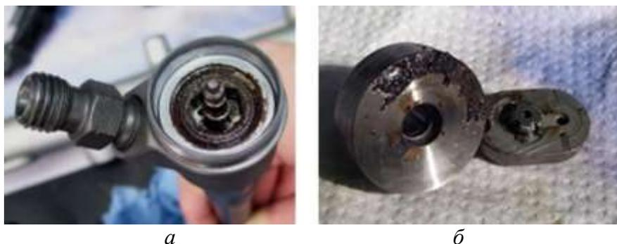
Рисунок 3 – Элементы коррозии деталей топливной аппаратуры:
