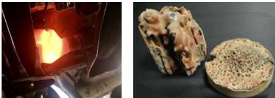
Рисунок 1 – Перегрев в аварийных КН: а - фото перегретого КН; б - фото оплавленных блоков
