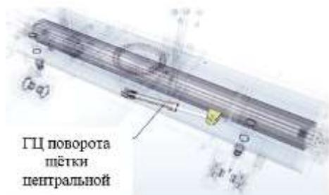
Рисунок 4 – Положение ГЦ поворота щётки центральной в составе щётки центральной
