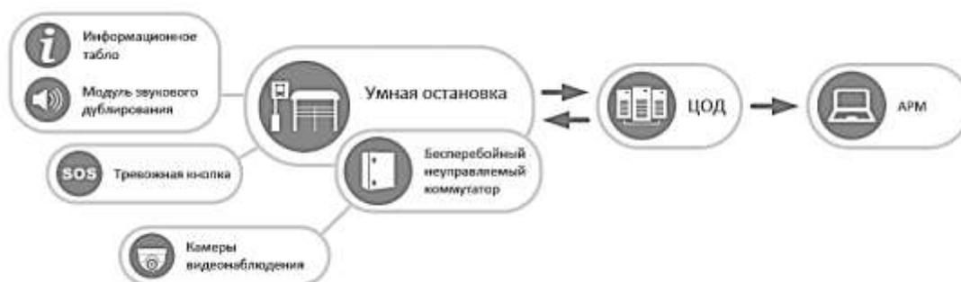
Рисунок 4 – Структурная схема подсистемы управления «умными остановками»
