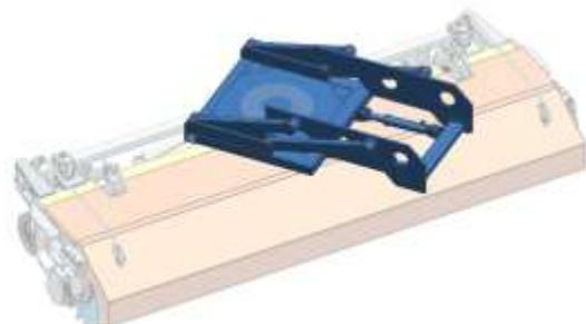
**Рисунок 2 – Математическая модель механизма подъема центральной щетки**
