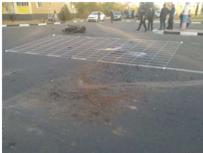
Рисунок 3 - Фотоизображения с места ДТП с наложением перспективной сетки в видеоредакторе Kinovea
