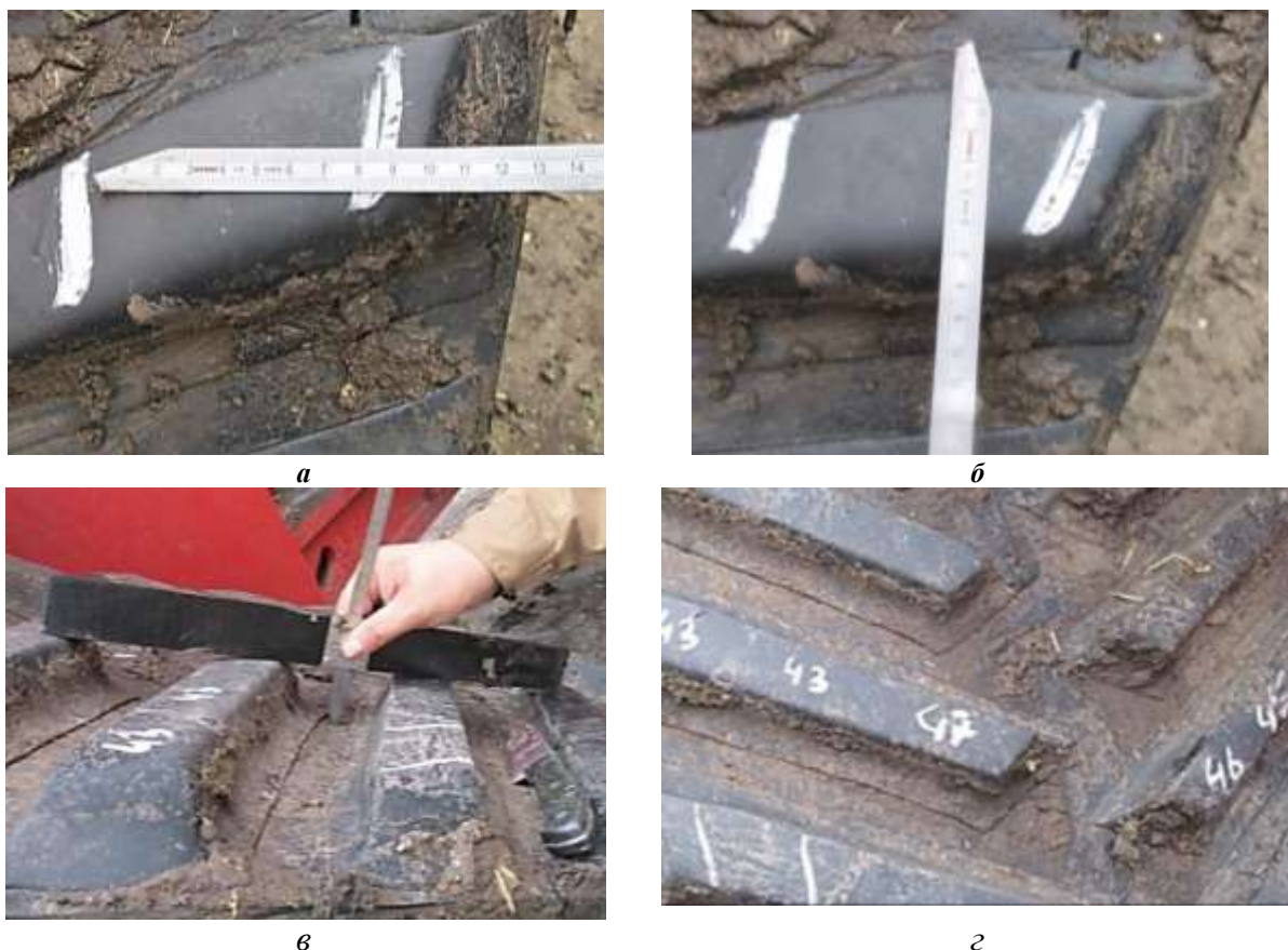
Рисунок 2 - Исследования геометрических параметров грунтозацепов: а - ширина вздутой части грунтозацепа; б - толщина вздутой части грунтозацепа; в - измерение высоты грунтозацепов; г - изменение высоты по длине грунтозацепа
