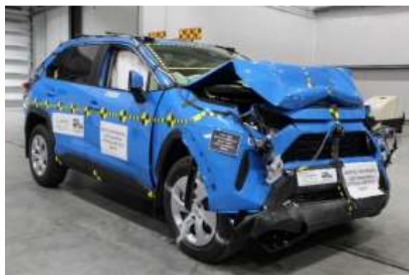
Рисунок 6 - Автомобиль Toyota RAV4 после проведения испытания на фронтальное столкновение
