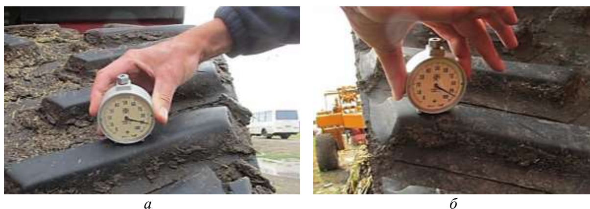
Рисунок 3 - Измерения твердости: а - грунтозацеп правой гусеницы; б - грунтозацеп левой гусеницы
