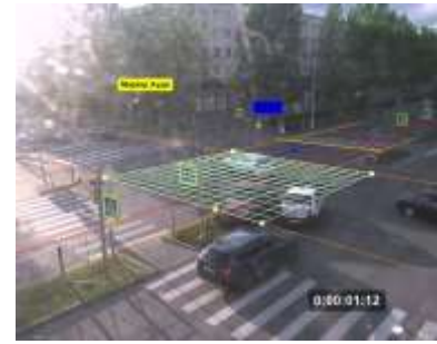
Рисунок 9 - Окончание трекинга маркера (положение маркера на Границе 3) и замера времени перемещения
