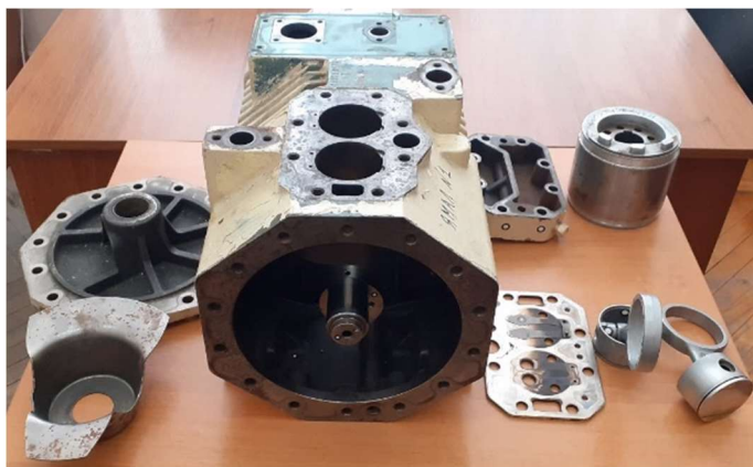
Рисунок 1 – Идентификация ключевых элементов компрессора
