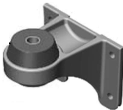
Рисунок 3 - Конструкция упругой опоры крепления кузова к раме
