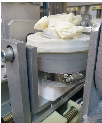
Рисунок 12 – Станок испытательной станции с испытуемым протезом внутри
