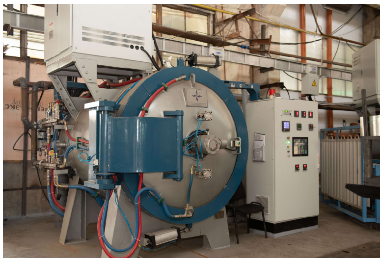
Рисунок 2 - Отжиговая печь PT-V1200-2531C фирмы «Zhengzhou Protech Technology Co., Ltd.».
