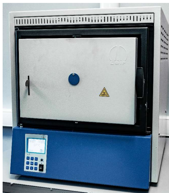
Рисунок 6 - Лабораторная электрическая муфельная печь АО "Лабораторное оборудование и приборы"
