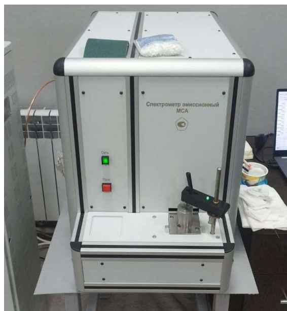
Рисунок 2 - Спектрометр эмиссионный МСА модификации МСАП V5 производства ООО «Спектральная лаборатория»
