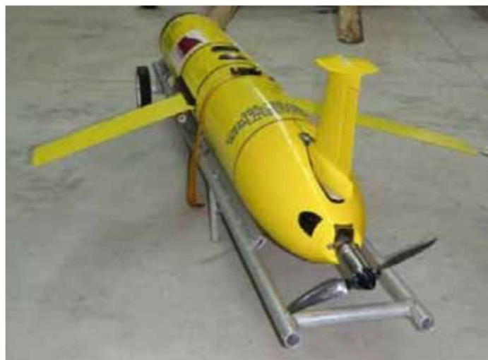
Рисунок 1 – Гибридный вариант глайдера «Slocum»
