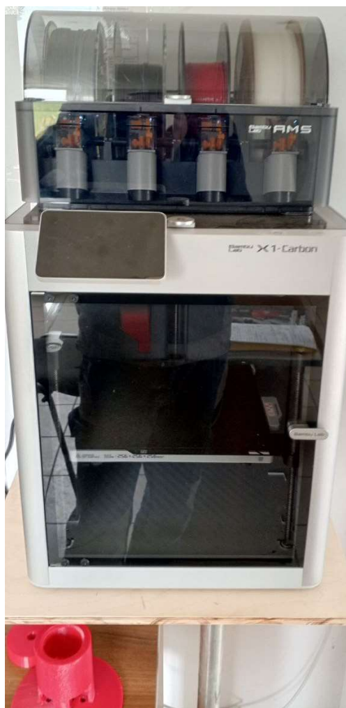
Рисунок 3 - Работа 3d-принтера фирмы Bambu Lab X-1 Carbon (Model Pf001-P) по изготовлению запасной детали для технологического оборудования животноводческого комплекса Компании «Залесский фермер» (г. Полесск Калининградской области)
