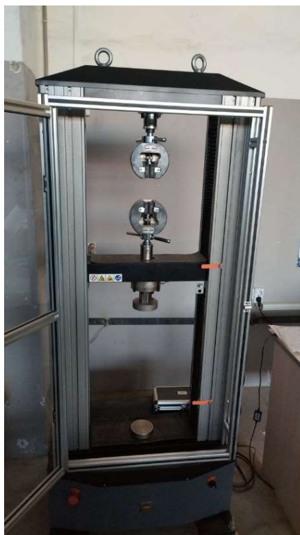
Рисунок 5 - Машина испытательная универсальная РЭМ-50-А-1-1 фирмы Метротест
