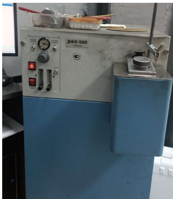
Рисунок 1 - Оптико-эмиссионный спектрометр для анализа металлов ДФС-500 производства ООО «ОКБ Спектр»
