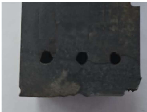
Рисунок 2 – Экспериментальный образец толщиной 20 мм после сквозного прокола
