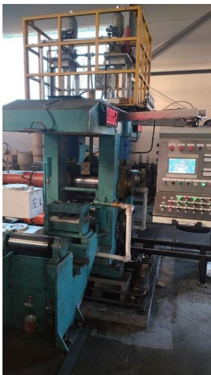
Рисунок 3 - Стан четырехвалковый реверсивный холодной прокатки Ø80/Ø350x350 фирмы Wuxi Xinbao Heavy Industry Technology Co., Ltd.
