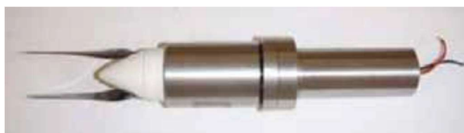
Рисунок 2 – Двигательный модуль глайдера «Slocum»
