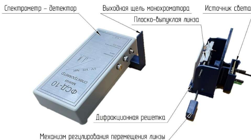
Рисунок 6 – Схема проведения эксперимента с функциональным прототипом монохроматора
