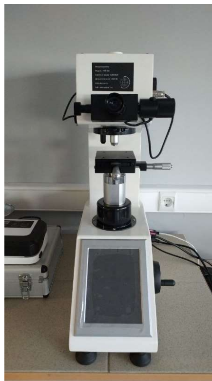
Рисунок 6 - Микротвердомер PMT-3М фирмы "Восток-7"
