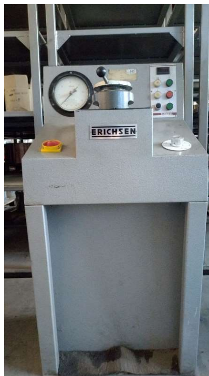
Рисунок 4 - Машина для испытания на глубину выдавливания фирмы Erichsen.
