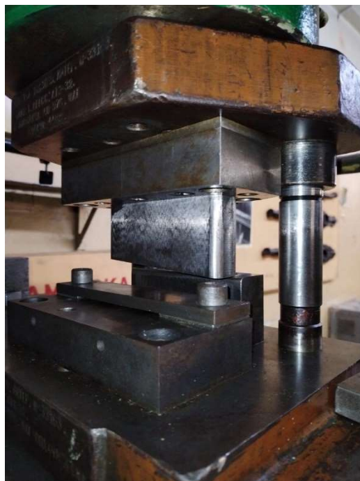
Рисунок 2 – Штамповая оснастка со сменными ножами для отрезки заготовки
