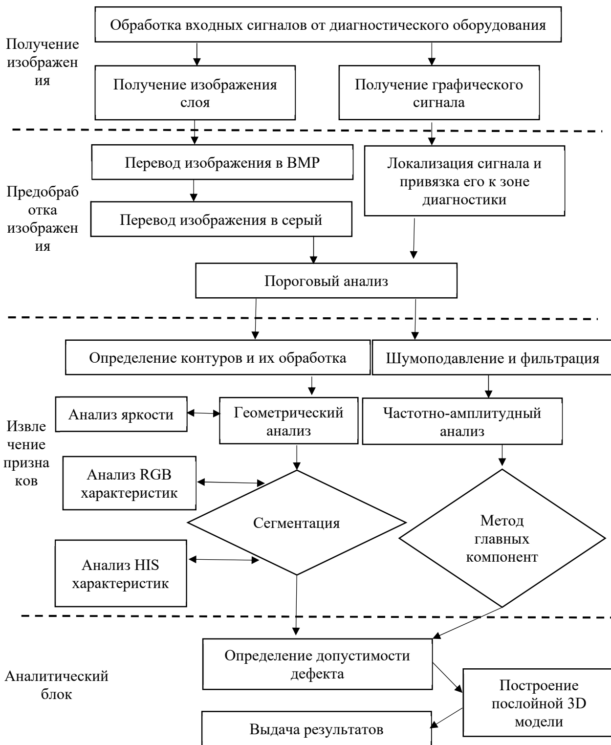
Рисунок 3 - Алгоритм выявления дефектов методами компьютерного зрения и графовой нейронной сети
