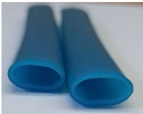
Рисунок 1 - Вариант пластической деформации гибкой оболочки при комплексном нагружении
