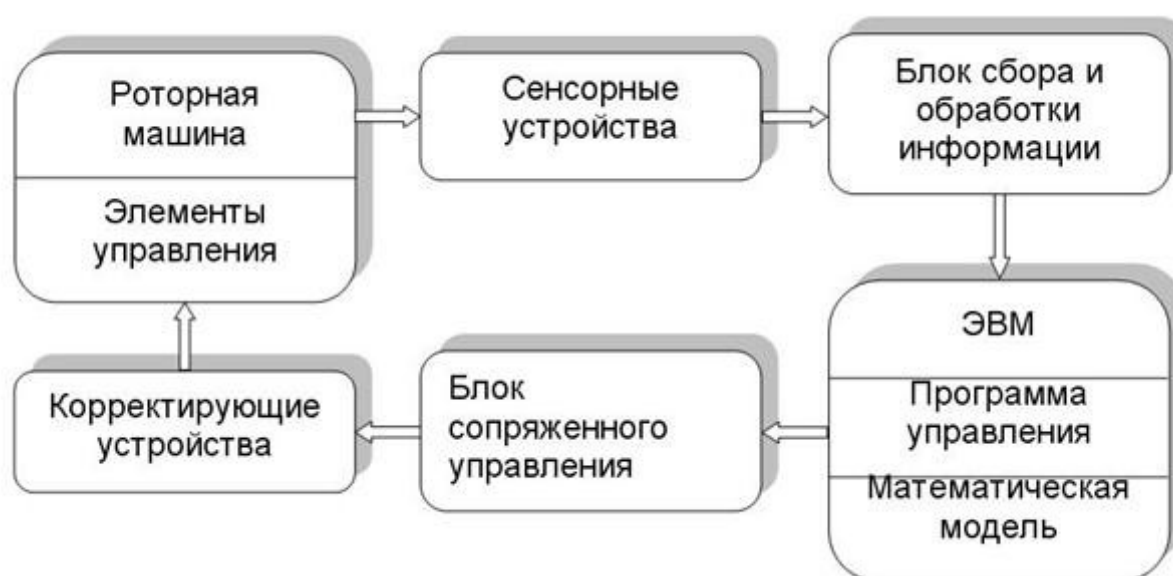
Рисунок 1 – Принципиальная схема активного управления
