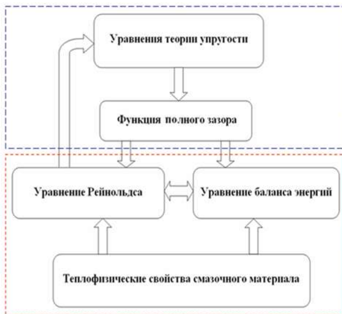
Рисунок 2 – Блок-схема решения комплексной задачи расчета полей давлений в смазочном слое подшипника
