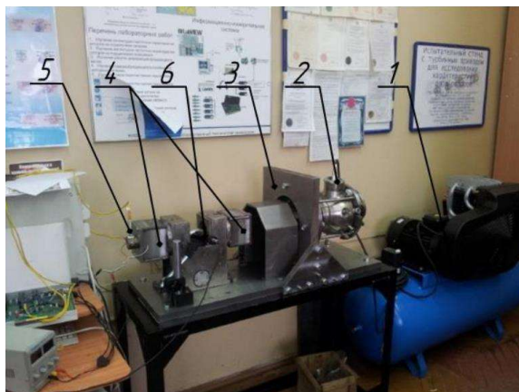
Рисунок 2 - Экспериментальный стенд с турбинным приводом для исследования комбинированных подшипников с активным управлением
