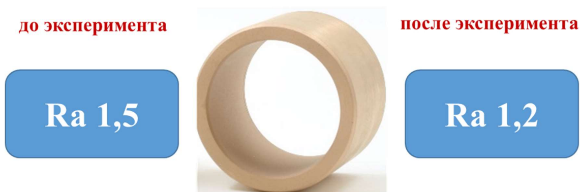
Рисунок 5 – Параметры шероховатости подшипника скольжения (материал – бронза)
