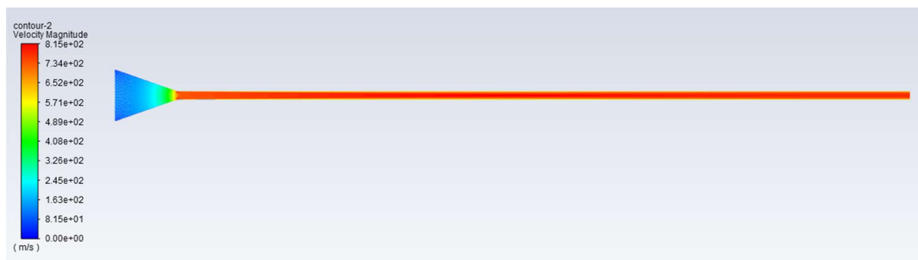
Рисунок 4 – Моделирование скорости движения потока жидкости в фокусирующей трубке сопла
