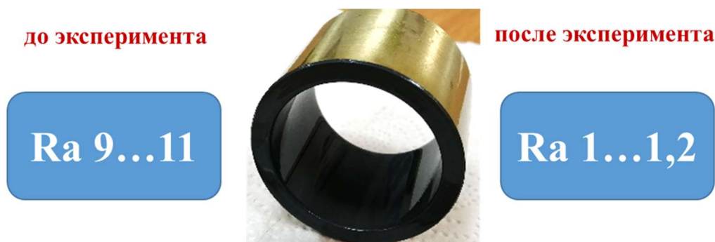
Рисунок 9 – Параметры шероховатости подшипника скольжения (материал – MODENGY)
