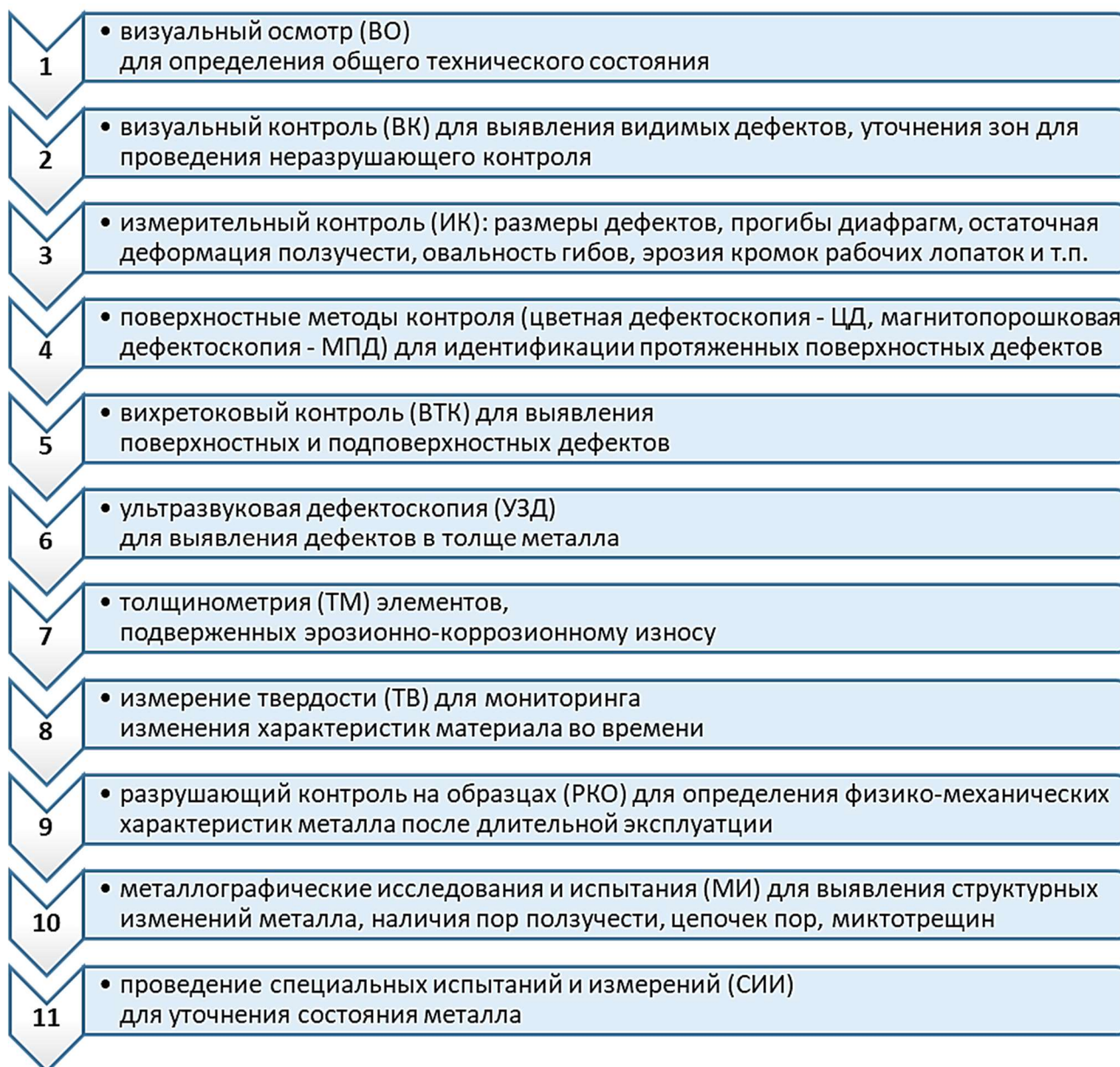
Рисунок 1 – Расширенное диагностирование ресурсопределяющих узлов турбины
