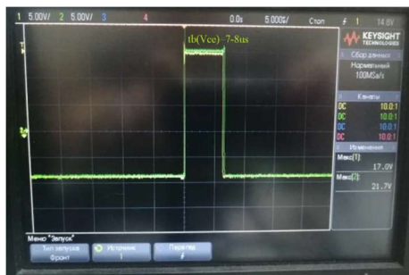
Рисунок 10 – Время задержки на срабатывание монитора DESAT
