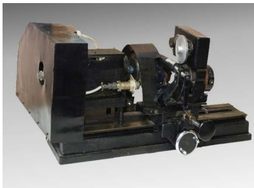
Установка моделирования сложного вращения колец подшипника с заданными частотами вращения и характером нагружения
