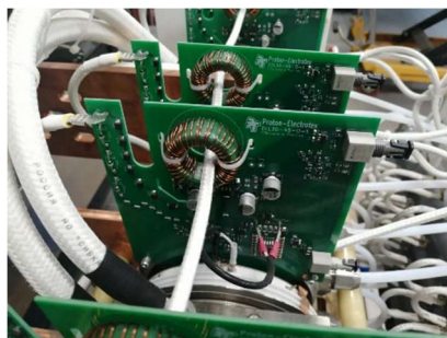
Рисунок 27 – Питание драйвера по «токовой петле»
