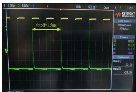
Рисунок 12 – Время блокировки управления каналом 1,5 мс
