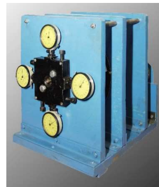
Установка моделирования заданных регулярных макроотклонений (овальность, огранка) дорожек качения
