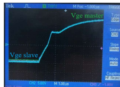
Рисунок 40 – Синхронное переключение параллельных модулей
