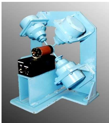
Установка моделирования местного и циркуляционного нагружения трибообъекта с заданной частотой
