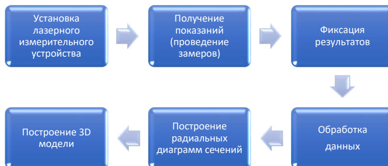
Рисунок 3 - Процесс построения корпуса вращающейся печи в 3D
