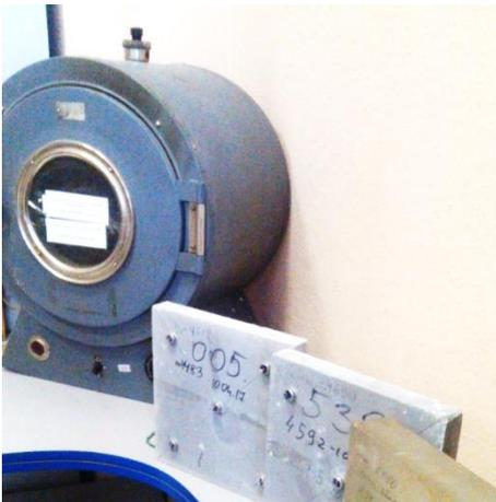
Рисунок 3 - Образцы из фибробетона и оптического стекла с термохронами
