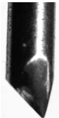
Рисунок 2 - Специальный щуп для снятия профилограммы
