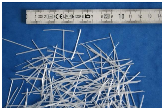
Рисунок 1 - Щелочноупорное макростекловолокно с приложением сосредоточенной нагрузки в четырех точках
