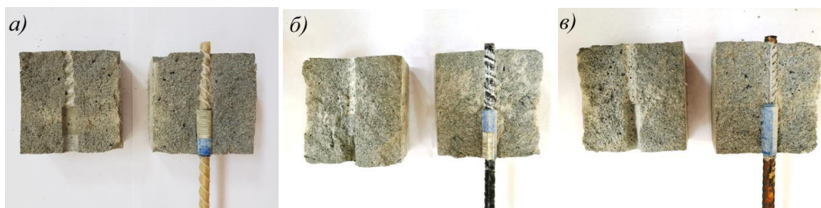
Рисунок 2 – Характер нарушения сцепления арматуры с поризованным бетоном: а) стеклокомпозитной; б) базальтокомпозитной; в) металлической
