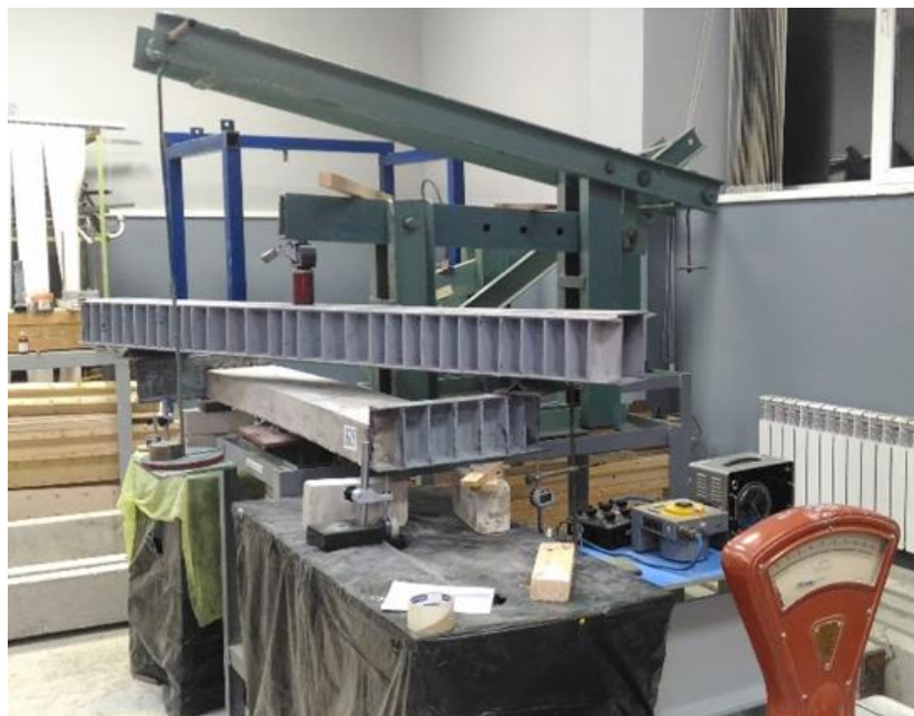
Рисунок 4 – Общий вид проведения экспериментальных исследований конструкций балочного (а) и плитного (б) типов
