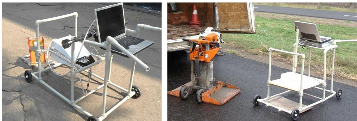
Рисунок 3 – Оборудование для георадарного обследования дорожных одежд
