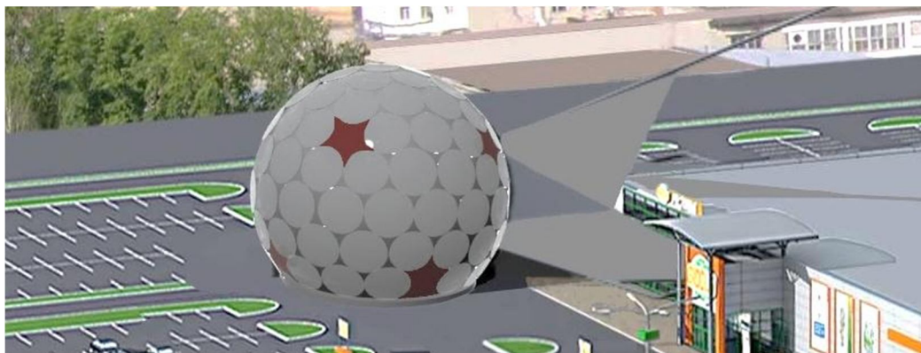
Рисунок 10 – Запроектированное сборное сферическое покрытие аквапарка пролетом 36 м на основе 1280-гранника
