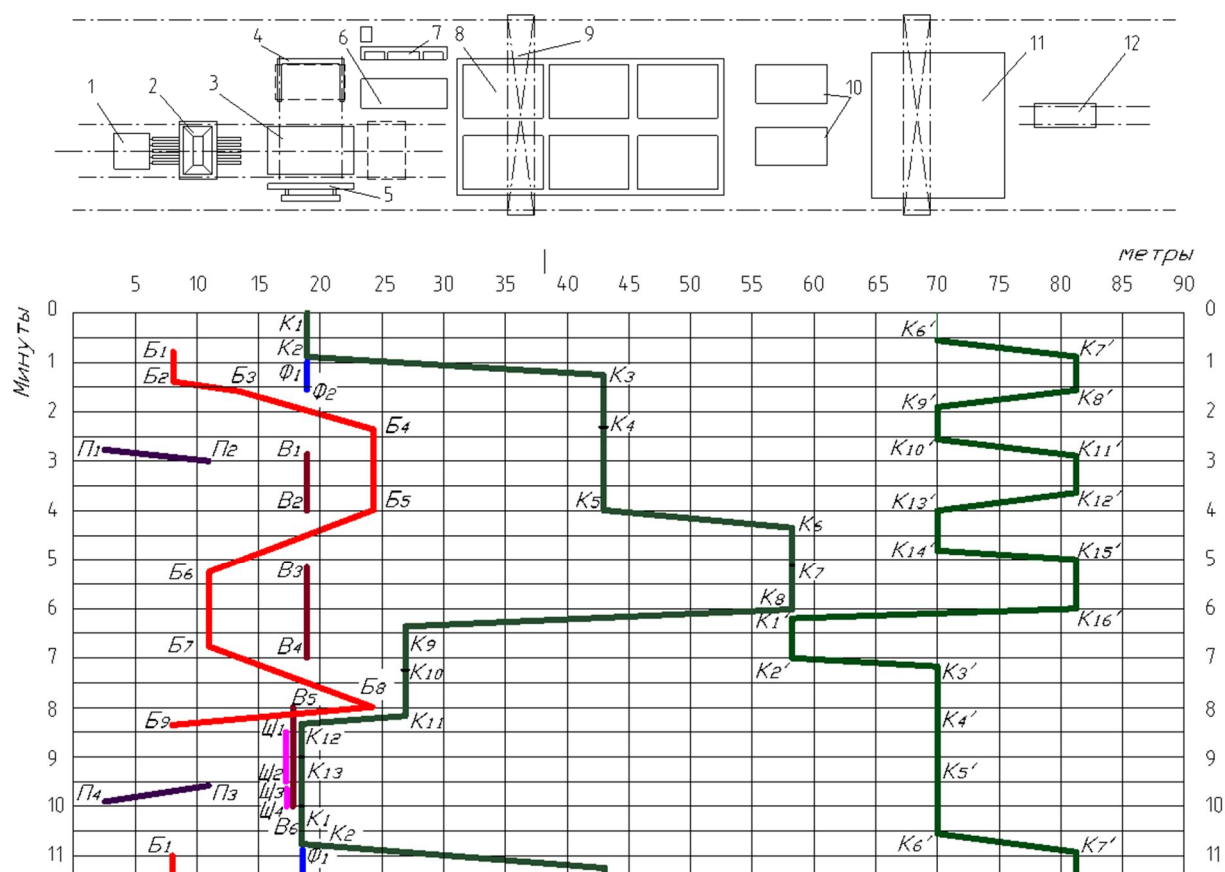
1 – каретка с пустообразователями; 2 – бетоноукладчик; 3 – виброплощадка; 4 – формоукладчик; 5 – пригрузочный щит; 6 – посты армирования форм; 7 – установка для электронагрева арматуры; 8 – камера тепловой обработки; 9 – мостовой кран; 10 – посты очистки и смазки форм; 11 – зона выдерживания изделий; 12 – самоходная тележка для вывоза изделий. К 1 ... К 13 – работа крана N 1 ; К 1 ' ... К 16 ' – работа крана N 2 ; Б 1 ... Б 9 – работа бетоноукладчика; В 1 ... В 6 – работа виброплощадки; Ф 1 ... Ф 2 – работа формоукладчика; П 1 ... П 4 – работа пустообразователя; Щ 1 ... Щ 4 – работа пригрузочного щита.
