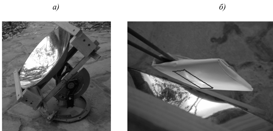
Рисунок 6 – Установка в виде параболоида вращения (а); распределение отраженного потока на приемнике (б)
