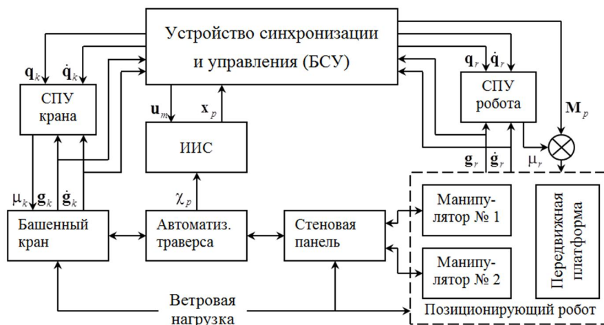
Рисунок 2 – Структура роботизированного монтажного комплекса
