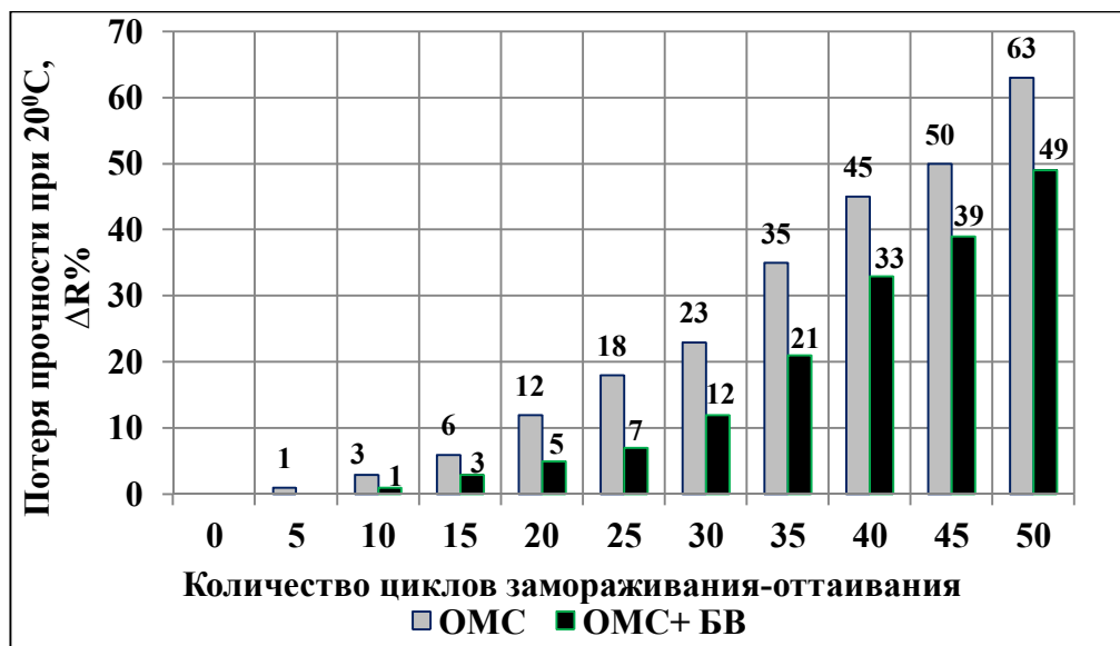
Рисунок 4 – Изменение потери прочности при сжатии при 20°C в зависимости от количества циклов замораживания-оттаивания.
