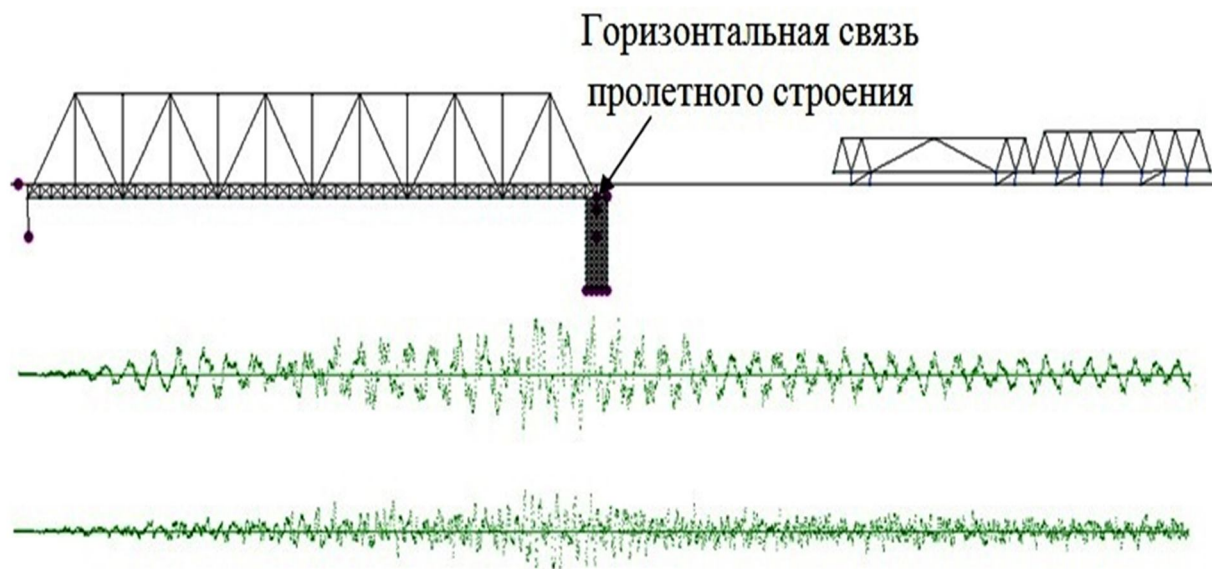
Рисунок 5 – Графики изменения горизонтальной опорной реакции от времени при скорости движения поезда 100 км/ч и массе подвижного состава 238 т. Время расчета 4 сек. Верхний график – жесткое крепление горизонтальной связи, нижний график – опирание горизонтальной связи на массивную упругую опору
