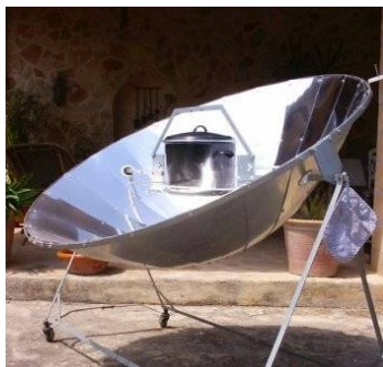
Рис.1. Печь с металлическими отражателями
