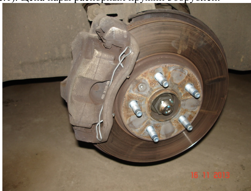
Рис.1 Суппорт переднего правого колеса автомобиля ChevroletCruze с пружиной марки 0542535
