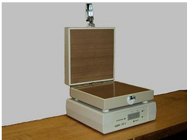
Рис. 6. PS-1 - печь для экспресс-анализа влажности по методу Чижовой
