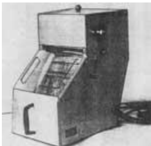
Рис. 2. Устройство для выделения металломагнитной примеси ПВФ-2
