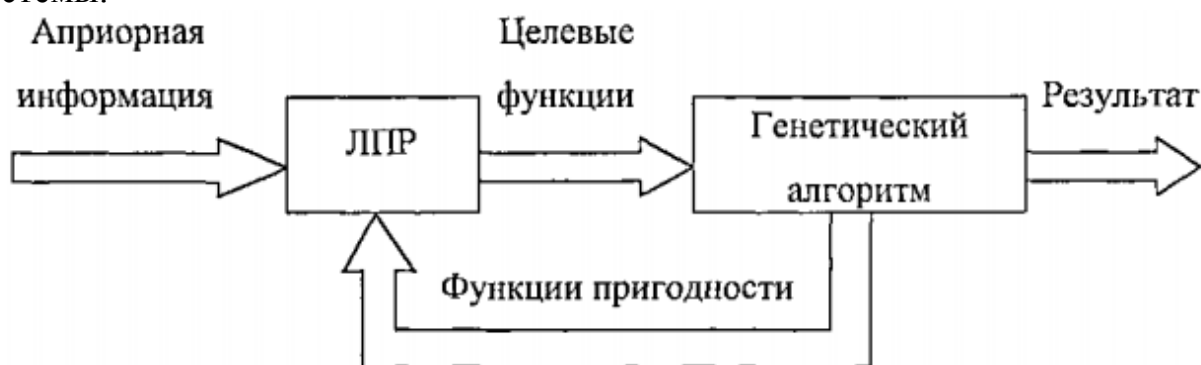
Рис. 1 Структурная схема работы генетического алгоритма [2]
