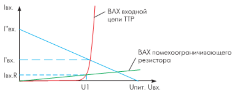
Рис. 5 – Графический расчёт входной цепи ТТР с токовым входом (этап 3)
