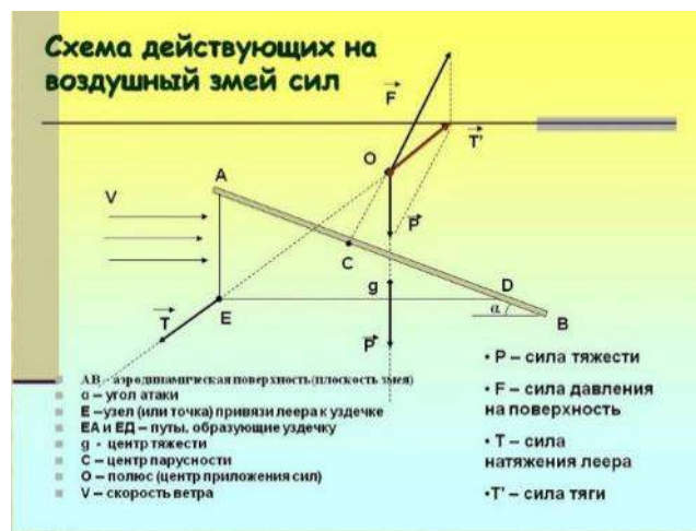
Рисунок 2 - схема действующих на воздушный змей сил
