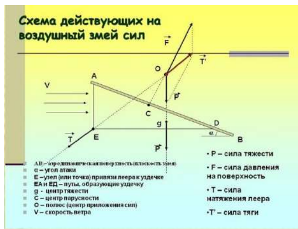
Рисунок 2 - схема действующих на воздушный змей сил
