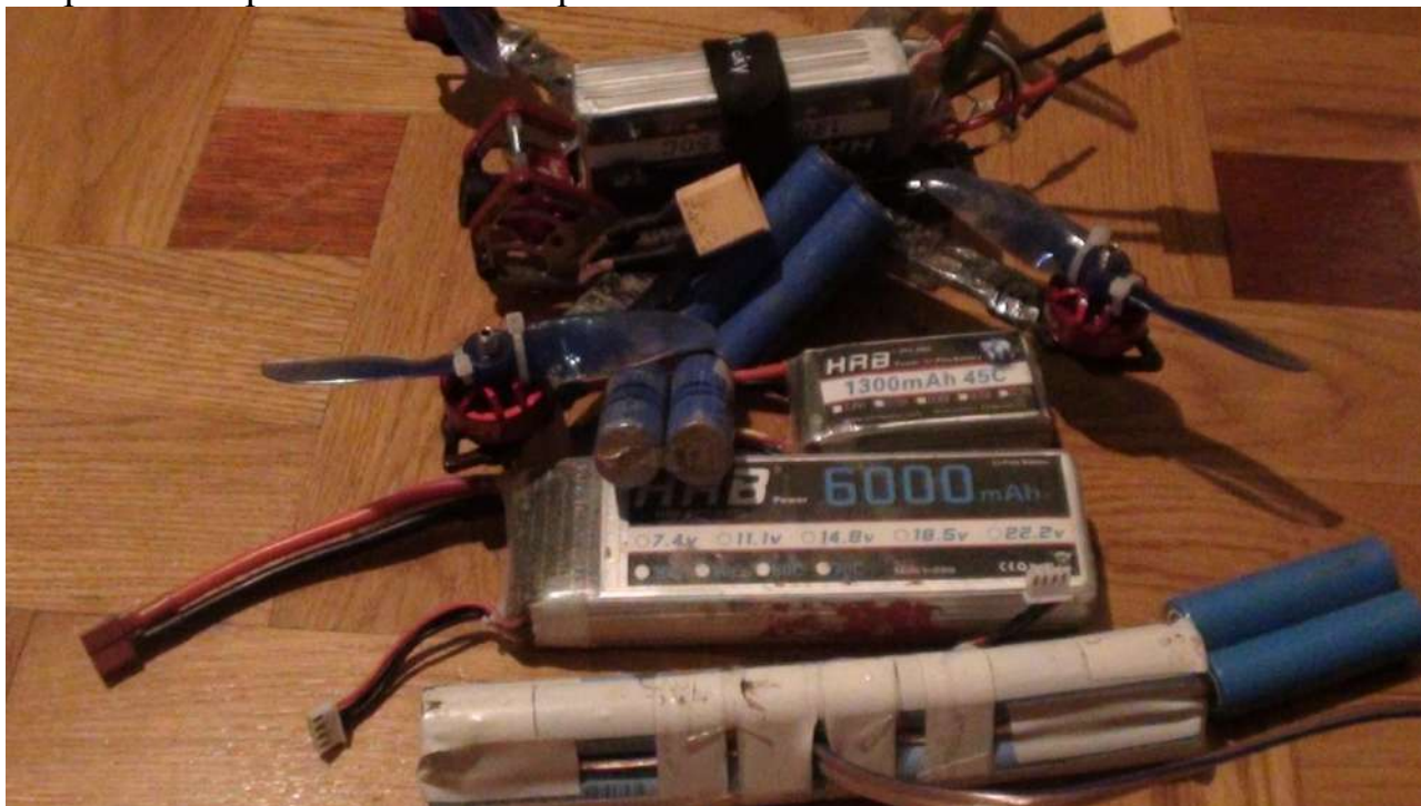
литий - полимерные батареи, литий - ионная сборка (снизу)
