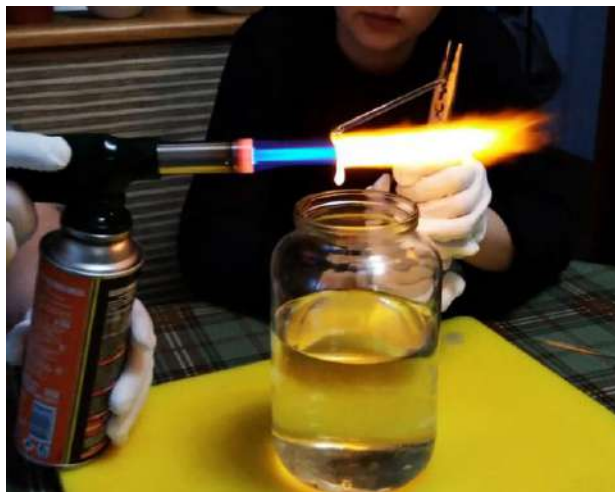
Рисунок 1 – образование капли из расплавленного стекла
