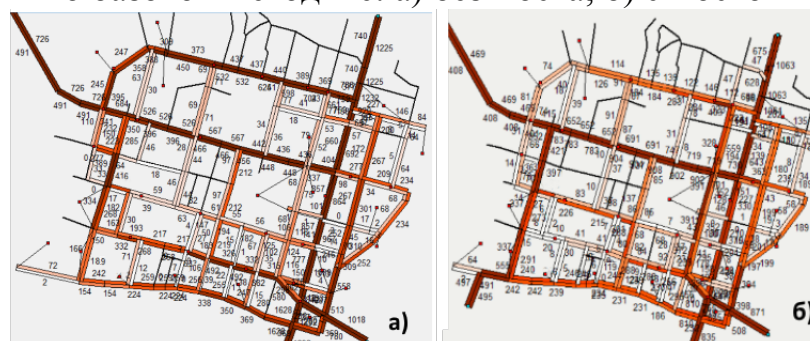
Рисунок 14 – Картограммы загрузки УДС в утренний «час пик», полученные по базовой методике: а) без моста; б) с мостом
