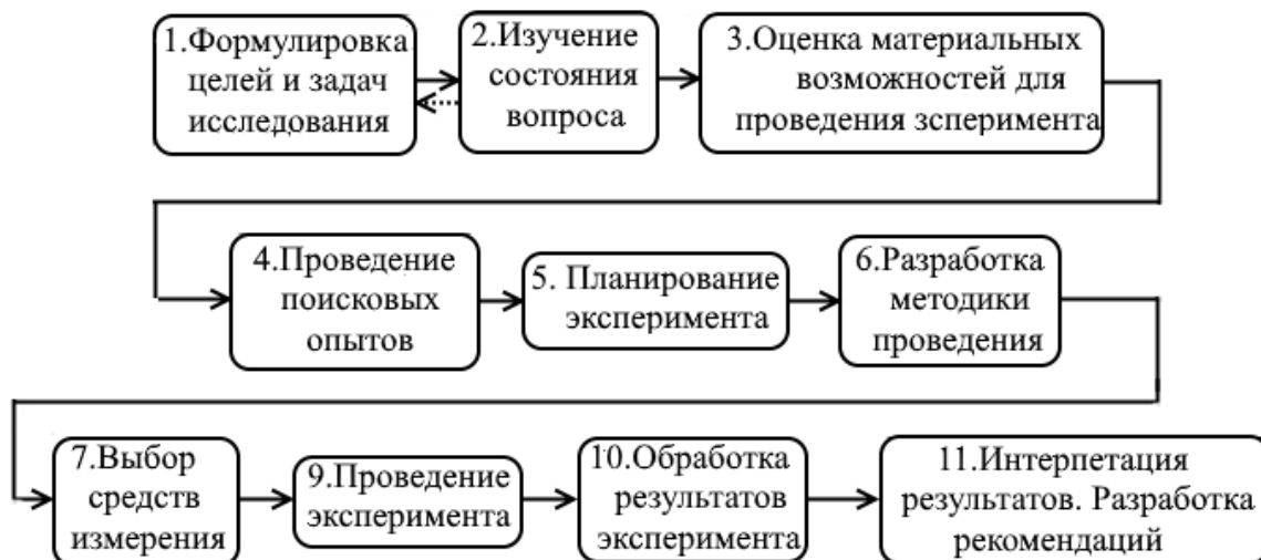
Рисунок 1 – Последовательность проведения экспериментального исследования
