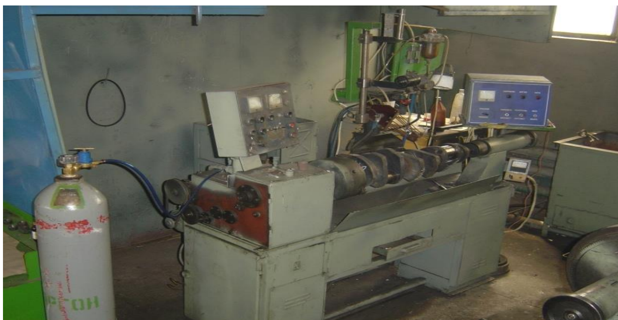
Рисунок 8 – Установка для плазменно-порошковой наплавки (общий вид)
