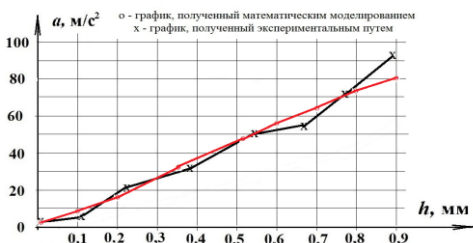
Рисунок 13 - График зависимости величины виброускорения от величины осевого зазора испытательных образцов
