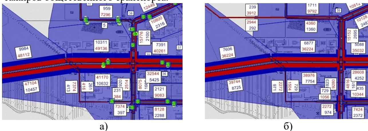
Рисунок 6 – Распределение транспортной нагрузки: а) при существующем пассажиропотоке и маршрутной сети; б) при прогнозируемом пассажиропотоке
