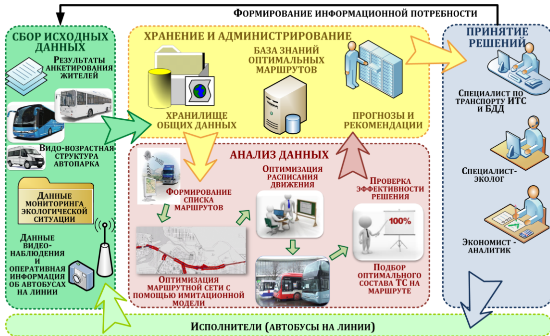
Рисунок 1 – Концептуальная модель системы управления городскими автобусными перевозками
