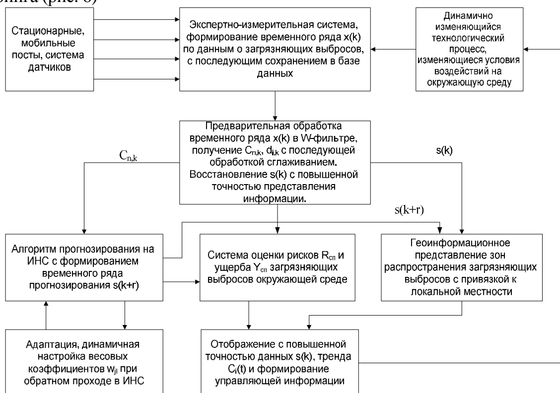
Рис. 6. Обобщенная структурная схема автоматизированной системы мониторинга загрязняющих выбросов
