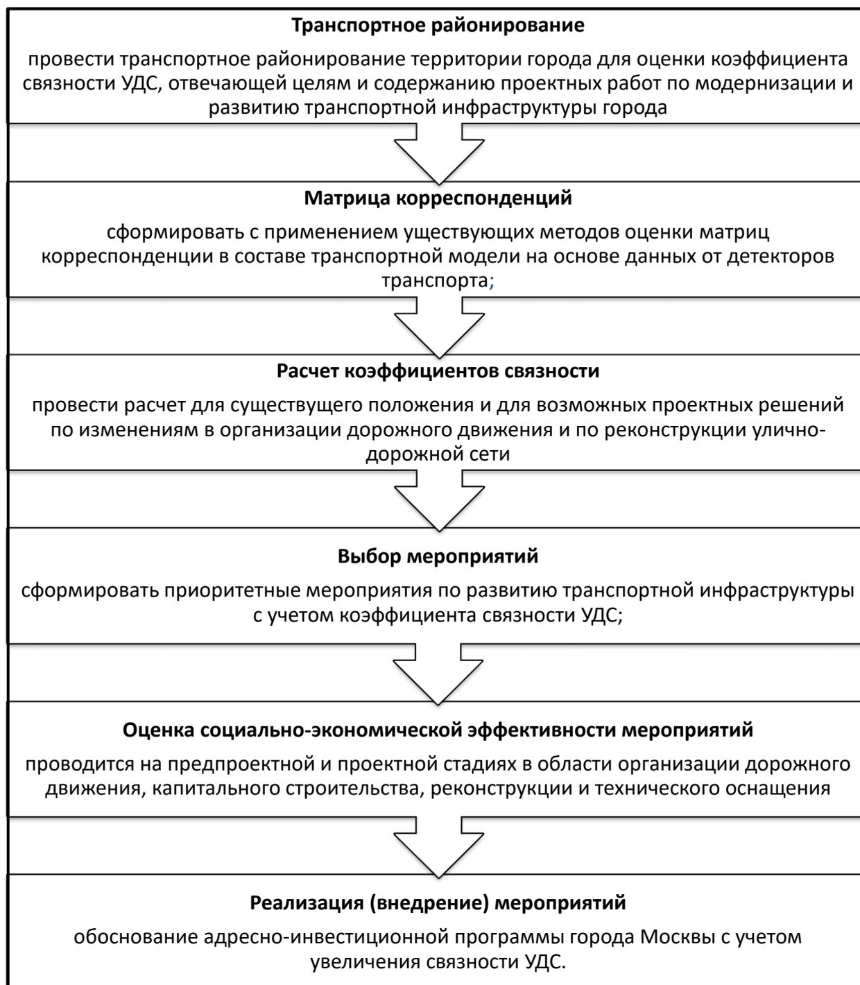
Рисунок 1 - последовательность действий по повышению эффективности функционирования транспортного комплекса города на основе увеличения связности улично-дорожной сети
