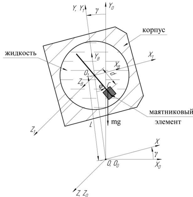
Рисунок 3 – Системы координат, определяющие движение маятникового чувствительного элемента
