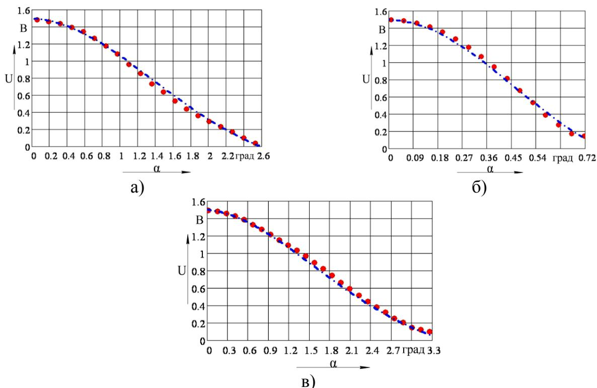
Рисунок 8 – Теоретические и экспериментальные статические характеристики датчика с камерой диаметром 30 мм: а) пьезодиски диаметром 10 мм, частота 2,14 МГц; б) пьезодиски диаметром 10 мм, частота 6,54 МГц; в) пьезодиски диаметром 6 мм, частота 2,87 МГц
