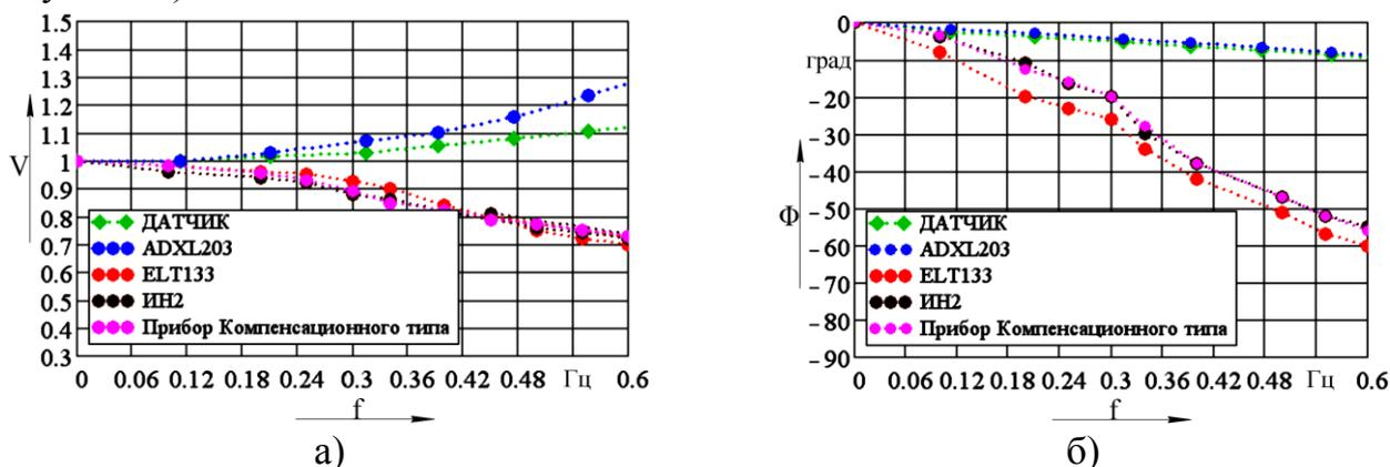
Рисунок 11 – Динамические характеристики исследуемого и известных датчиков:
