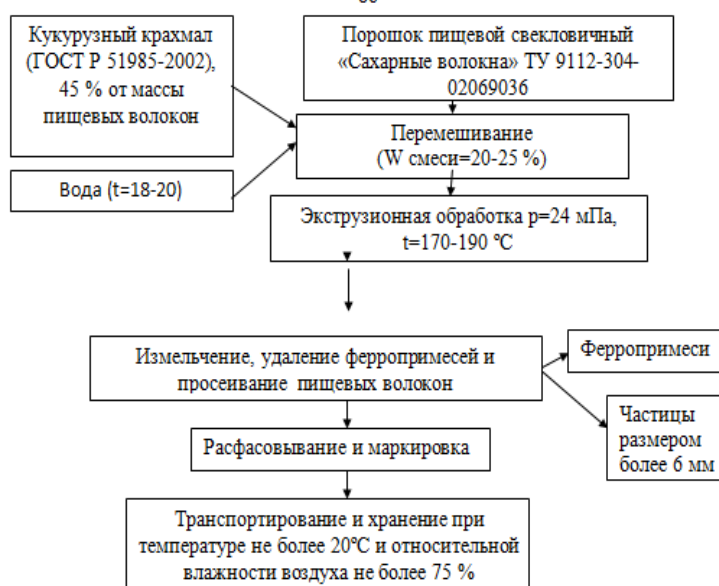
Рисунок 3 – Принципиальная технологическая схема производства экструдированных пищевых волокон из обессахаренной свекловичной стружки
