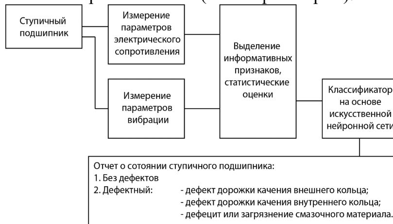
Рисунок 6 – Структурная схема метода диагностирования ступичного подшипника
