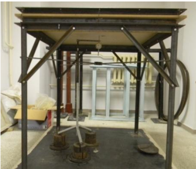
Рисунок 8– Испытательный стенд для экспериментальных исследований составных пластин
