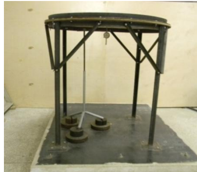
Рисунок 8– Испытательный стенд для экспериментальных исследований составных пластин
