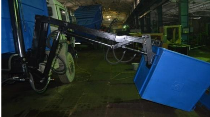
Рисунок 4 - Положение погрузочного оборудования во время тарировки
