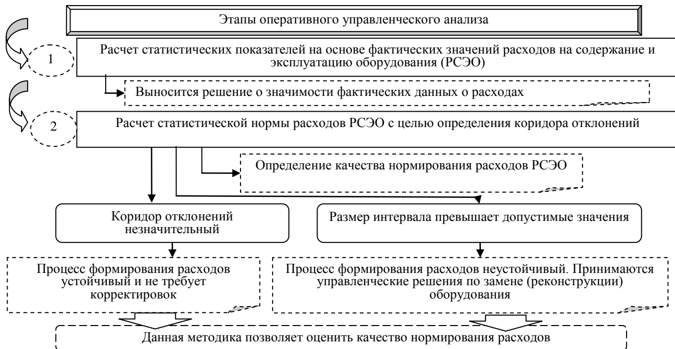
Рисунок 14 - Методика оперативного управленческого анализа расходов на содержание и эксплуатацию оборудования производственного предприятия
