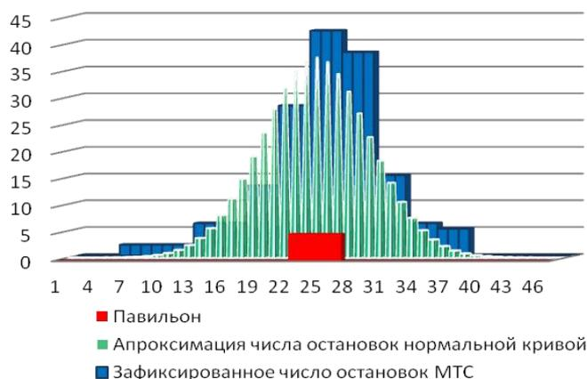
**Рисунок 8 – Гистограмма распределения точек остановки МТС на ОП «Донецкая»**
