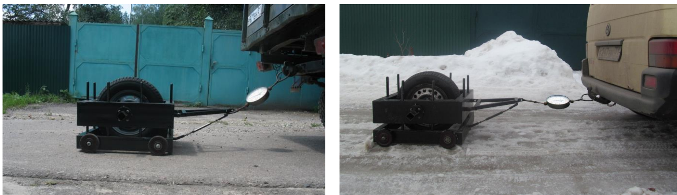
Рисунок 4 и 5 – Общий вид экспериментального стенда соединенного с ТС при испытаниях в летнее и зимнее время года соответственно
