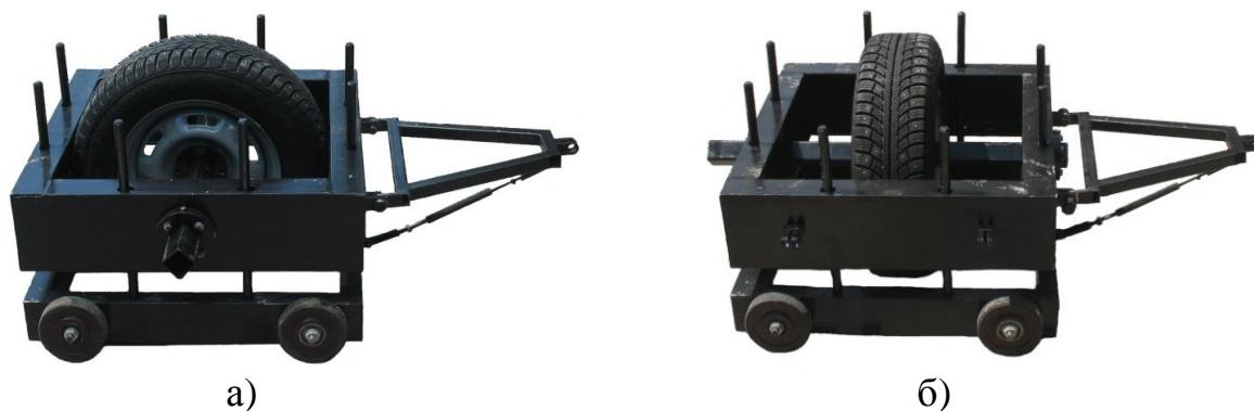
Рисунок 2 – Вид разработанной установки для измерения коэффициента сцепления шины колеса транспортного средства с опорной поверхностью
