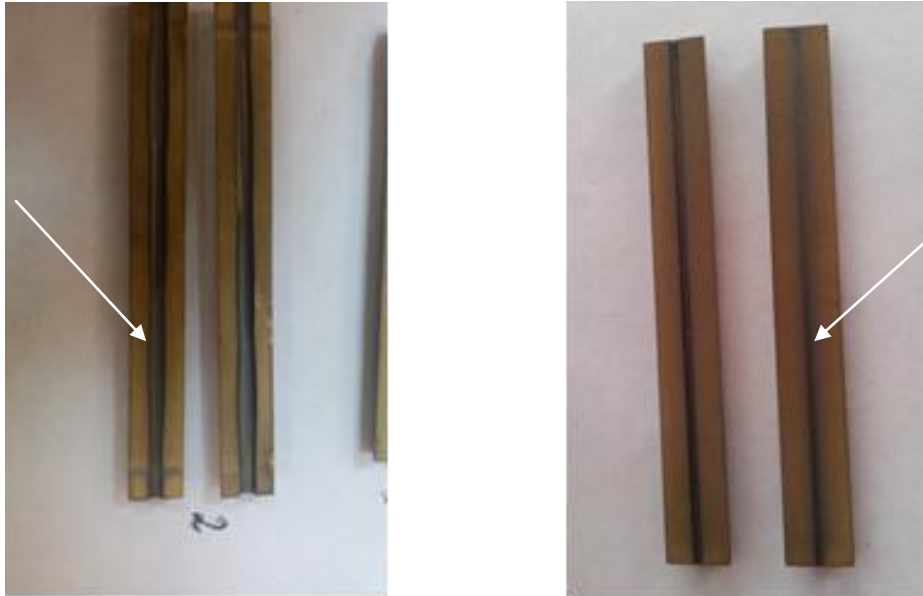
Рисунок 2 - Фотографии износа канала фокусирующей трубки
